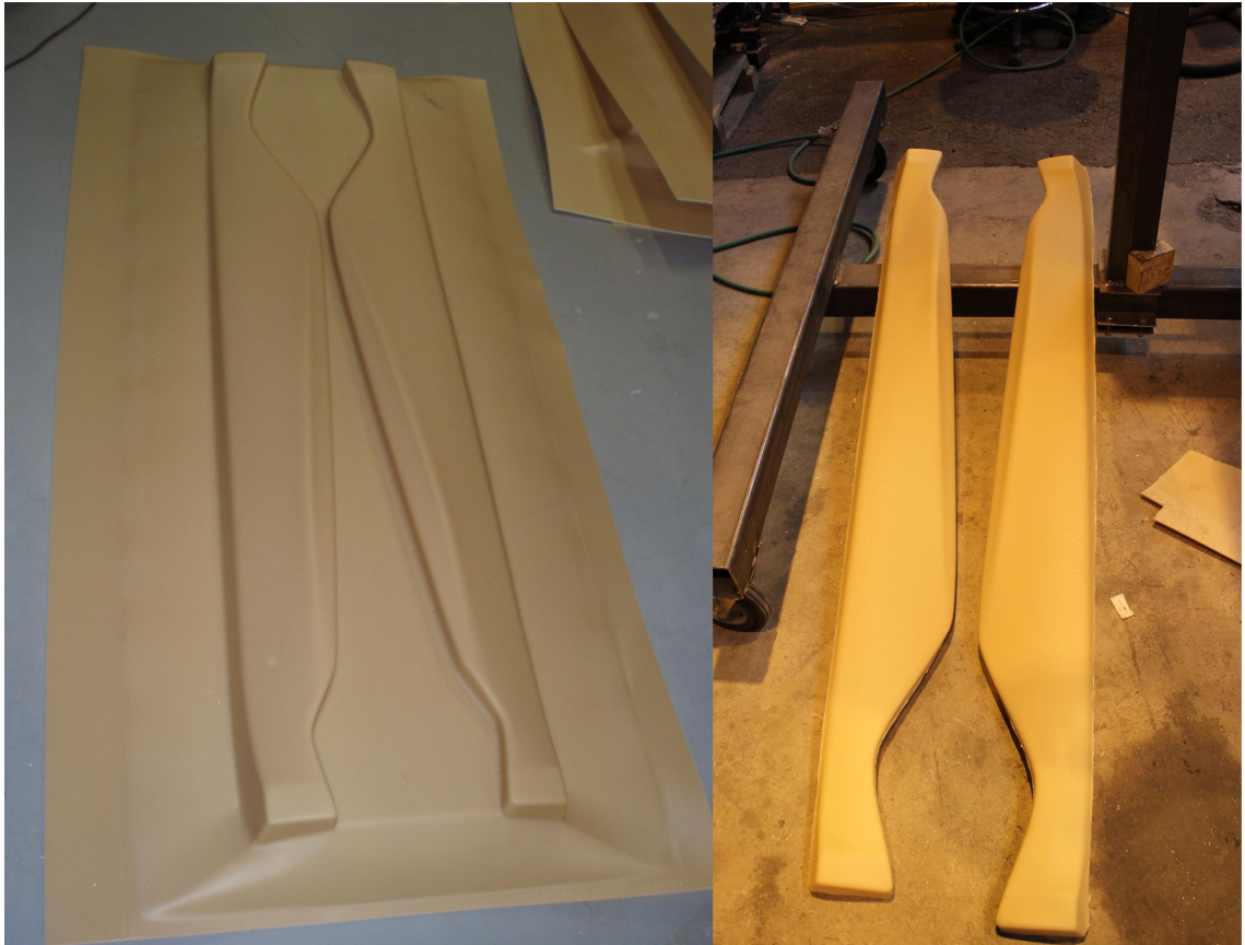
Kuva 20. Vasemmalla sivuhelmojen onnistunut alipainemuovaus urosmuotilla. Oikealla toisistaan irtileikatut helmat
