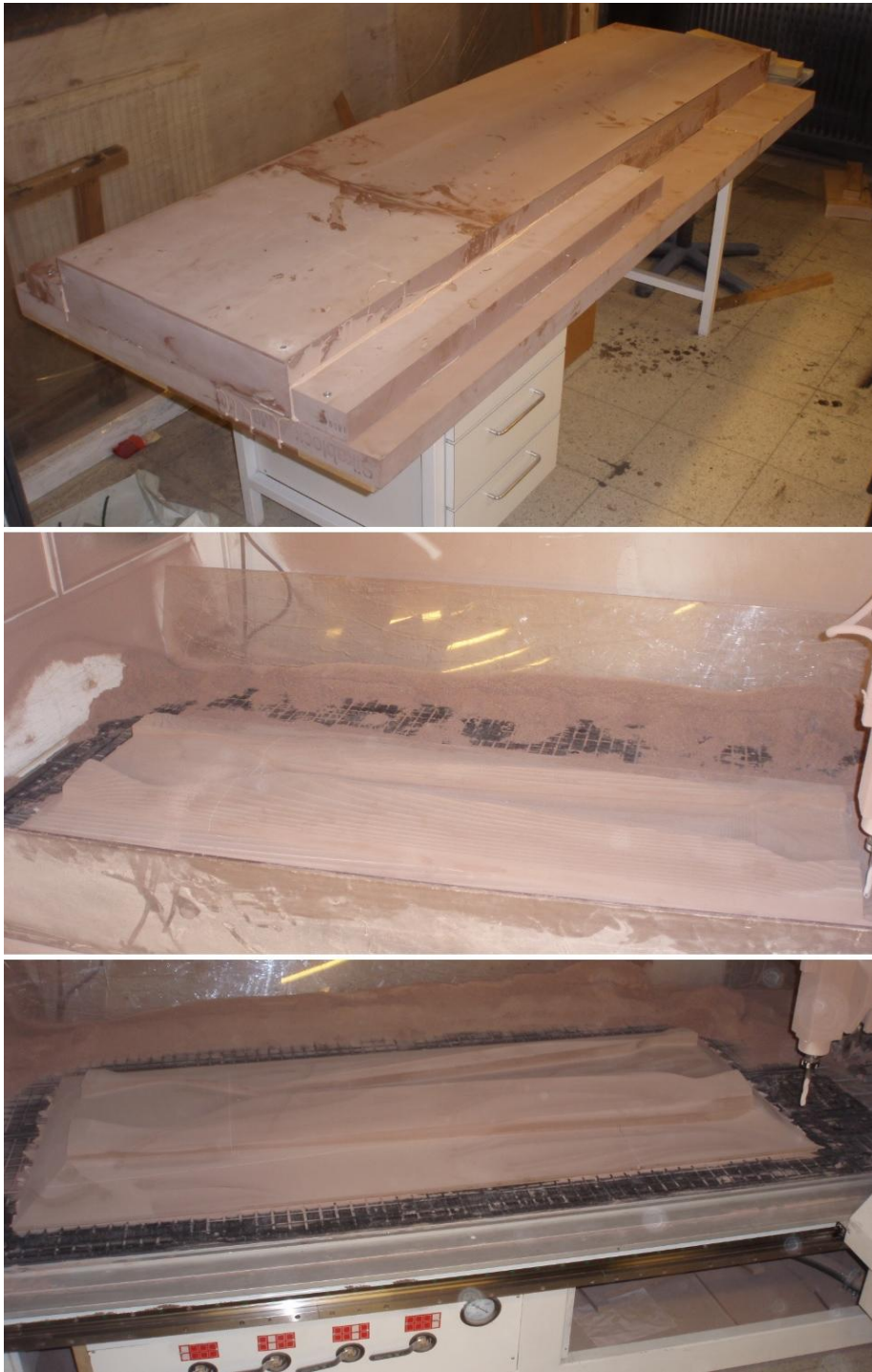
Kuva 17. Ylimpänä näkyy sivuhelmojen urosmuotin liimattu aihio, keskellä muotti rouhintavaihe suoritettuna ja alimpana viimeistelyvaihe suoritettuna
