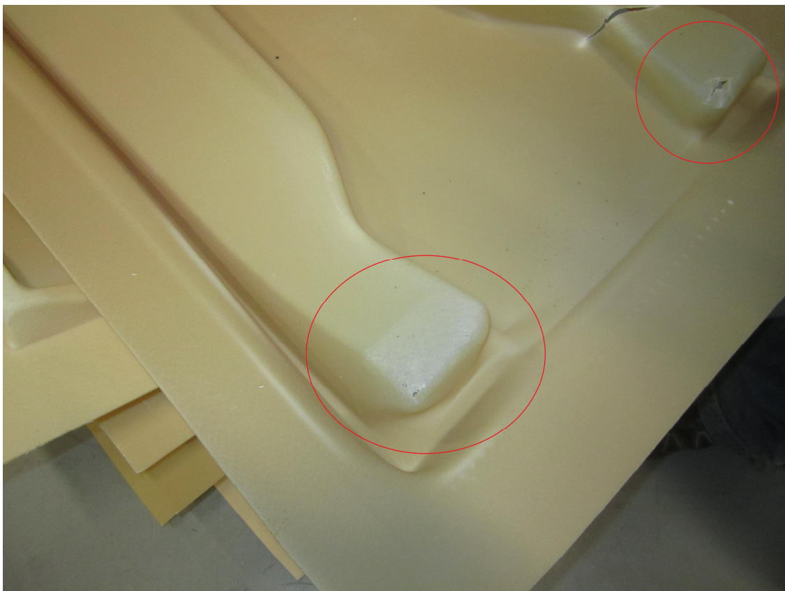
Kuva 14. Sivuhelmojen naarasmuotilla alipainemuovattu materiaalilevy. Punaisella ympyröity materiaalin oheneminen ja repeäminen
