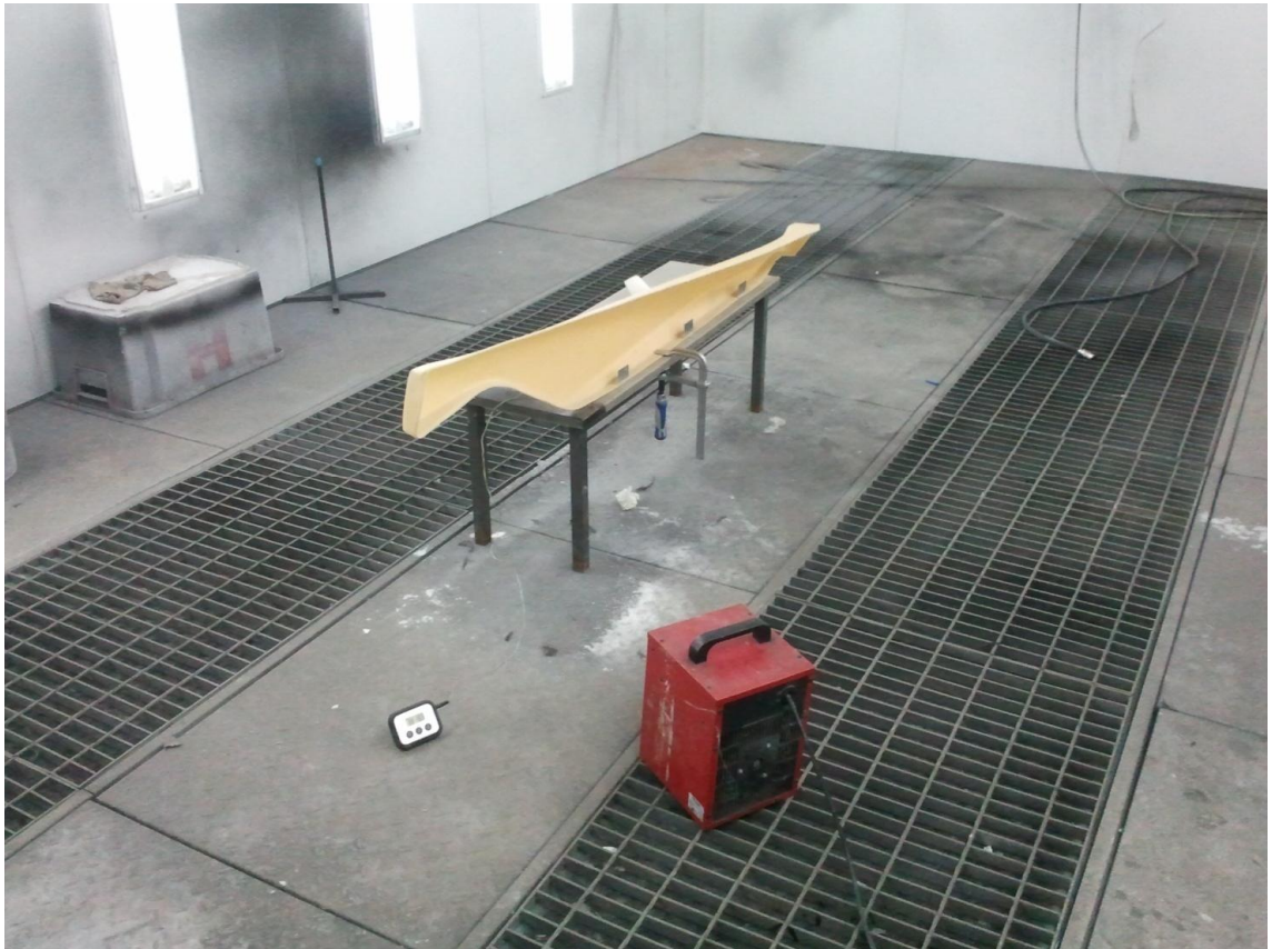
Kuva 25. Yläkiinnikkeiden liimaus helmaan lämmitetyssä maalausammiossa
