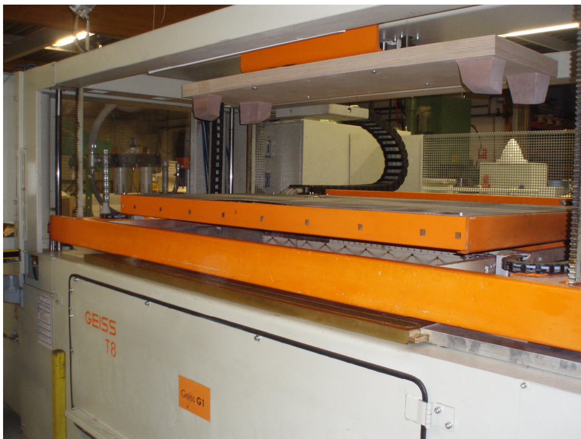
Kuva 15. Päätypainimet kiinnitettyinä alipainemuovaimen hydrauliseen prssiin
