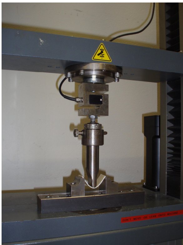
Kuva 1. Taivutuskoe käynnissä juuri ennen koepalan murtumista
