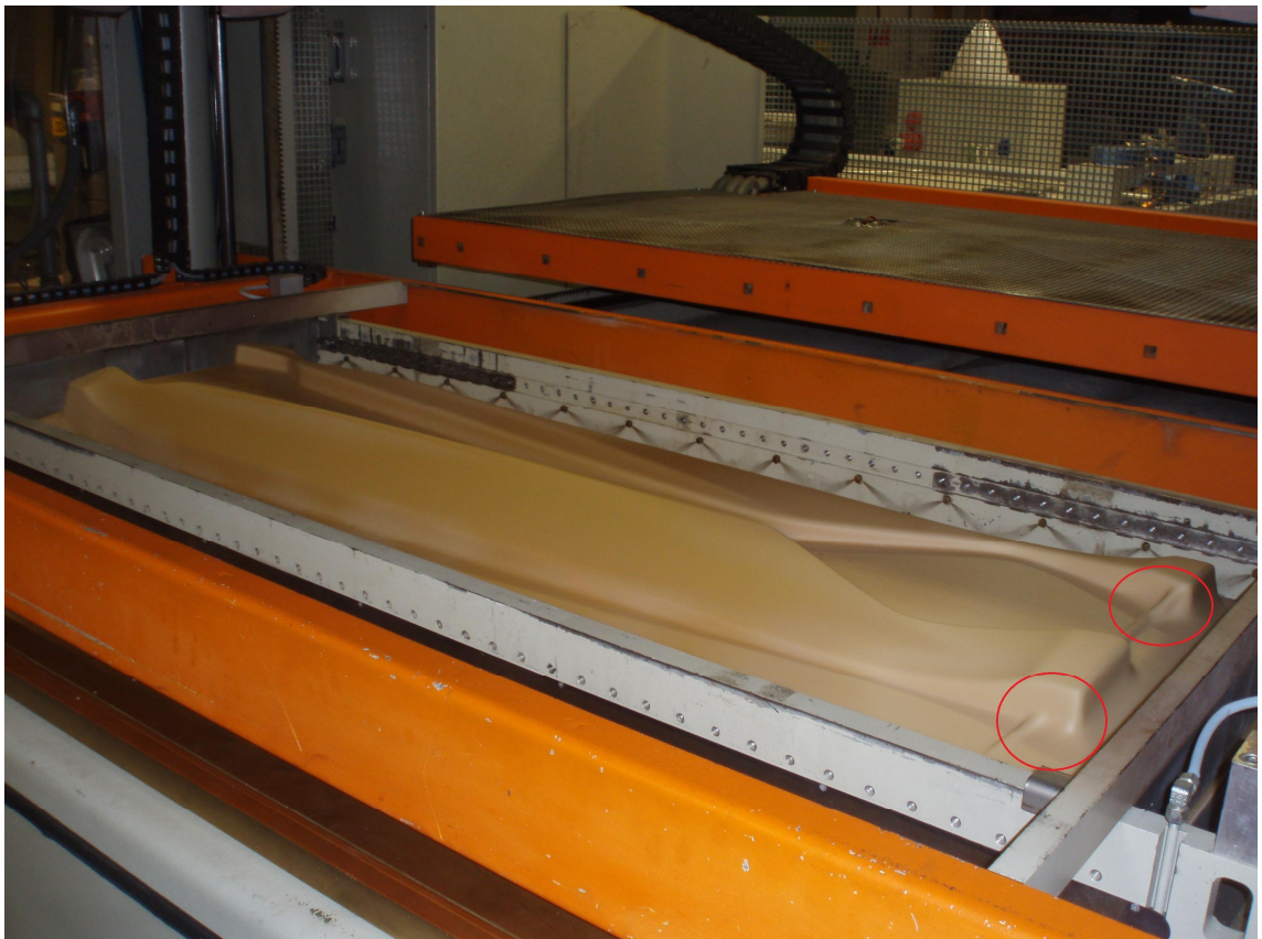
Kuva 18. Sivuhelmojen alipainemuovaus urosmuotilla. Punaisella on ympyröity muovausprosessissa syntyneet rypyt
