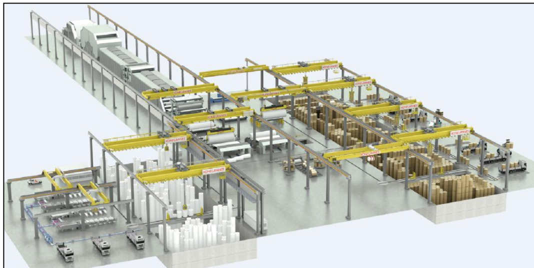
Kuva 7. Esimerkki paperitehtaan prosessinostureista (16)
