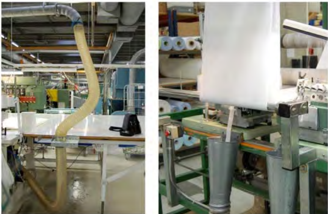
Kuva 1: valokuva tehtaan imurijärjestelmästä.
