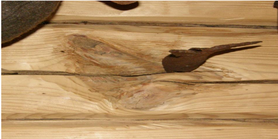
Kuva 22. Ruskolahon lahottama puu on poistettu oksan ympäriltä.
