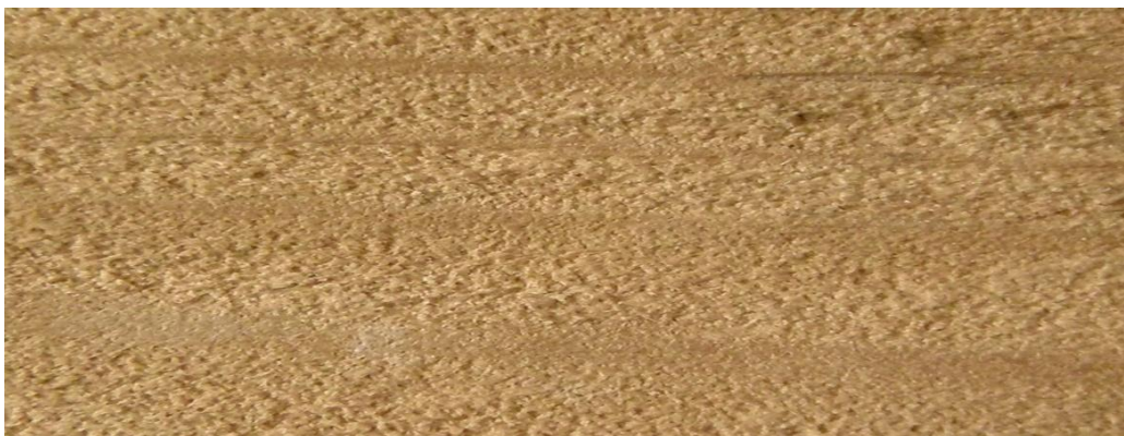
Kuva 10. Hiekkapuhallettua hirren pintaa.
