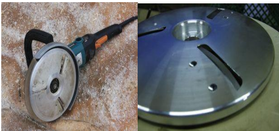
Kuva 19. piilutuslaikalla varustettu kulmahiomakone oikealla piilutuslaikka [15].
