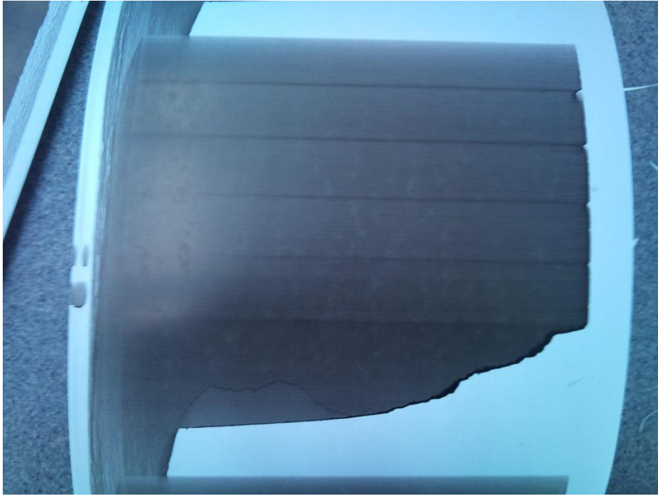
KUVA 9: Parhaan ajon ensimmäinen tulos nippipaineella 1 bar ja kiinnirullauksen kireydellä 3,5 bar.
