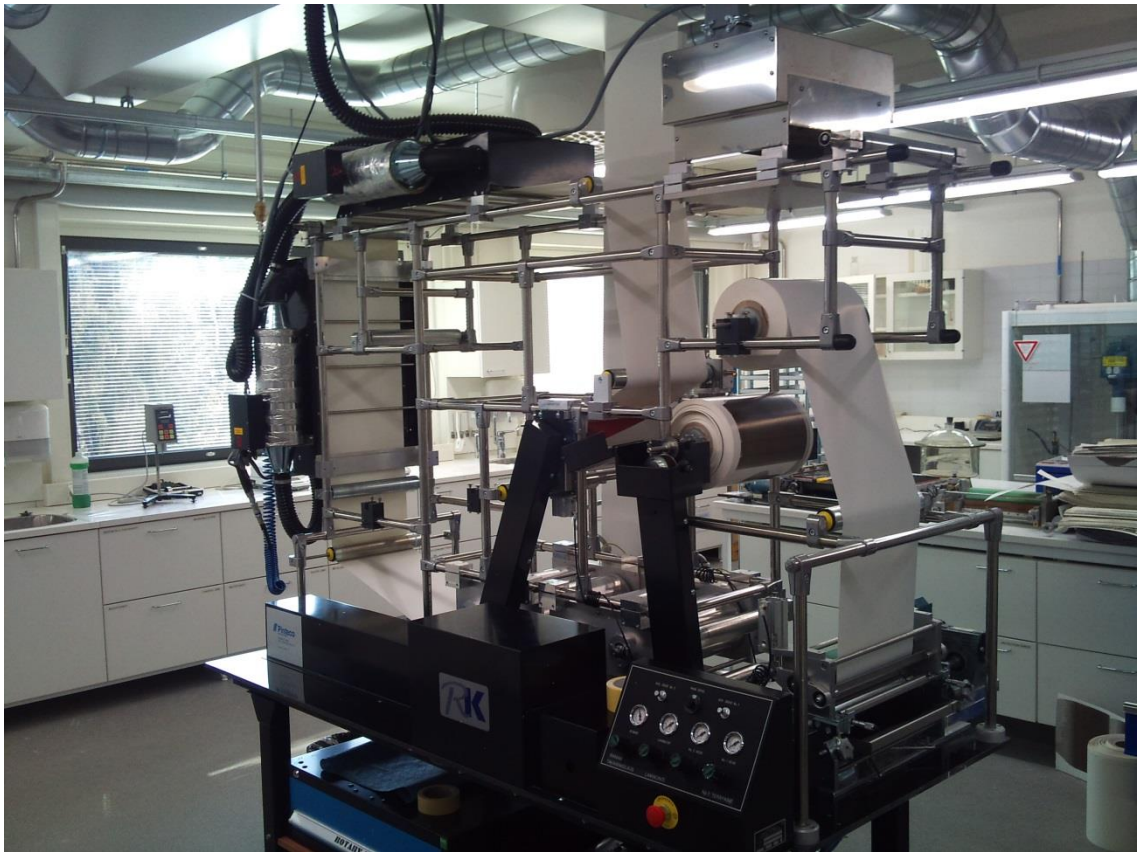
KUVA 7: Kartonkiradan vienti ROKO-pilotkoneella
