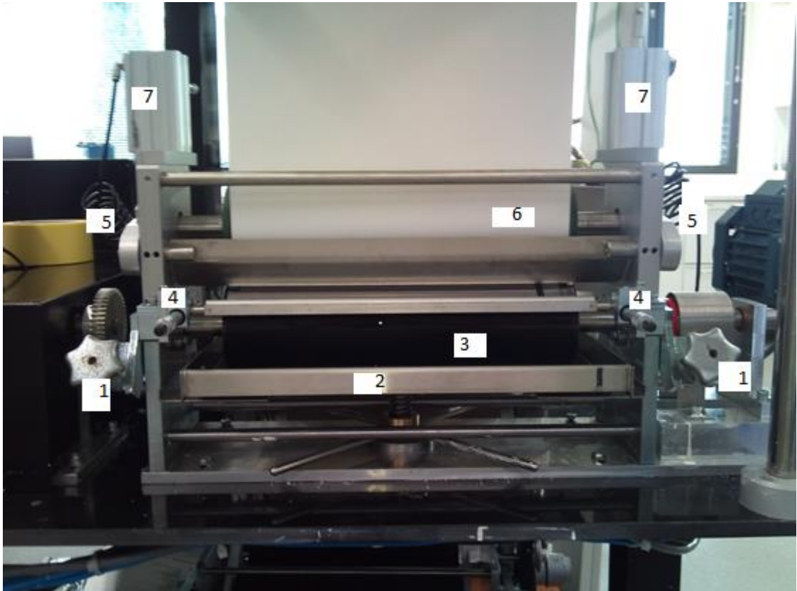
KUVA 4: Syväpainoyksikkö asennettuna ROKO-pilotkoneeseen
