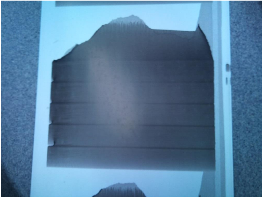
KUVA 11: Parhaan ajon kolmas tulos nippipaineella 4 bar ja kiinnirullaimen kireydellä 4 bar.
