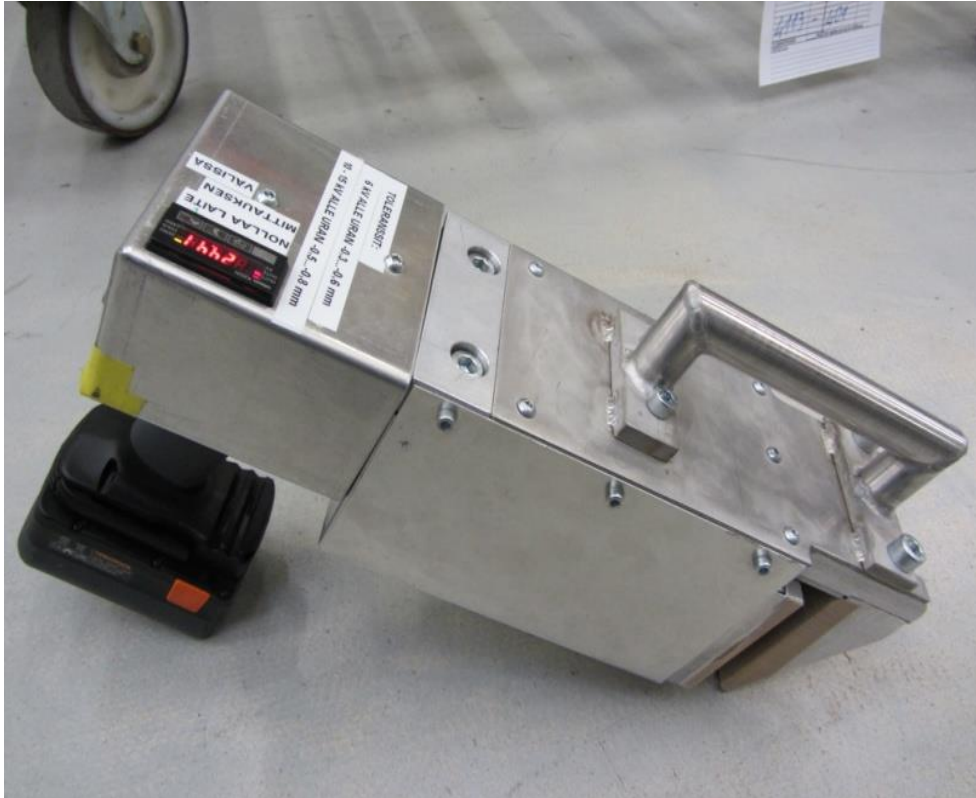
Kuva 16. Akkupora käyttöinen vyyhden paksuuden mittalaite.
