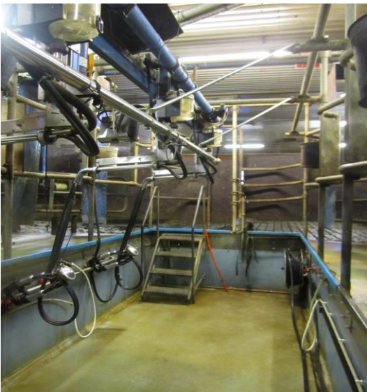
KUVIO 10. Kalanruoto swing-over-asema. Lypsimit saadaan aseman puolelta toiselle ja maitoputki on ylhäällä (Kuva: Marjo Liikanen)
