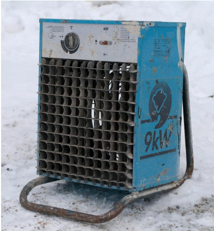
Kuva 26. Pienikokoinen 9 kW lämpöpuhallin. (Kuva: Juha Uusitalo)
