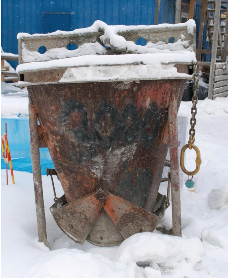
Kuva 1. Betonin nostoastia. (Kuva: Juha Uusitalo)
