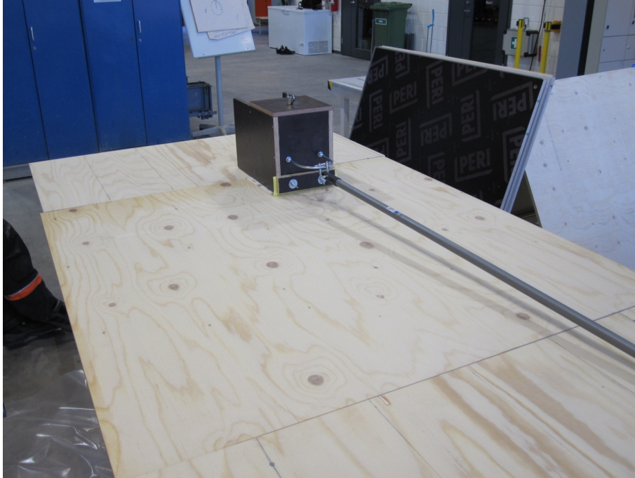
Kuva 10. Muottimateriaalin ”keinovanhennus” 10 kg:n kelkalla.
