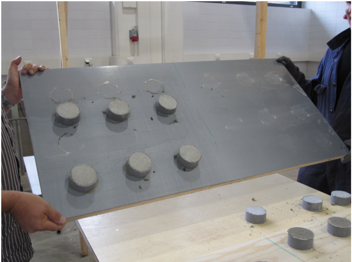
Kuva 21. Öljytyn levyn (muottilevy 5) kallistuskoee
