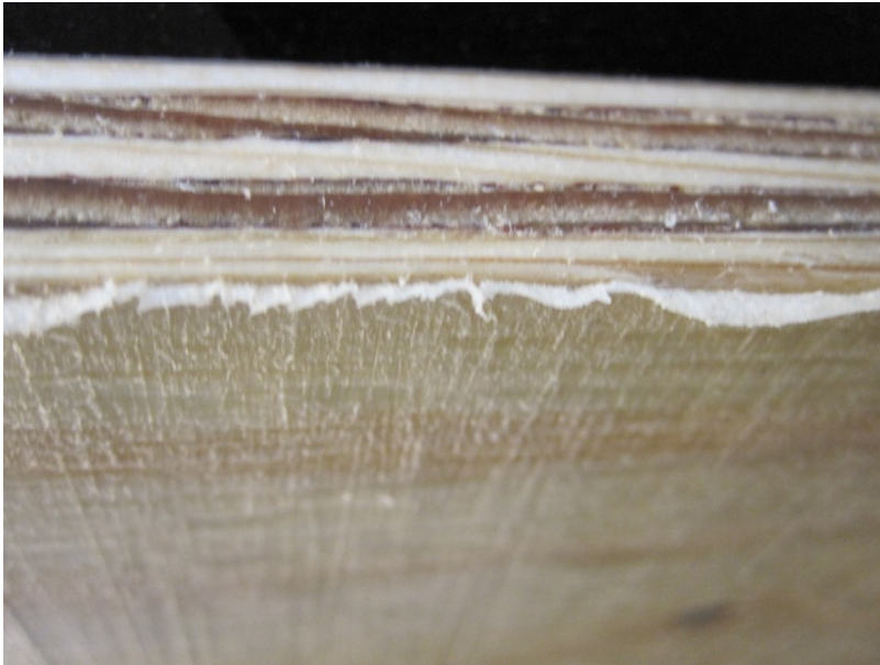
Kuva 14. Muottivaneri keinovanhennusten jälkeen
