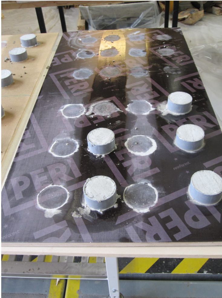
Kuva 22. Betonivalukappaleet öljytyllä muottipinnalla (materiaali 1)
