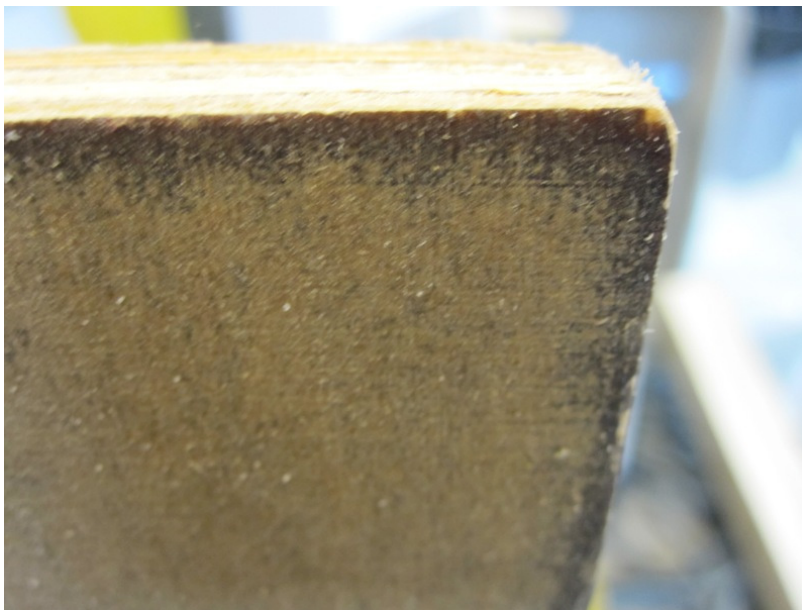
Kuva 12. Muottivaneri keinovanhennusten jälkeen
