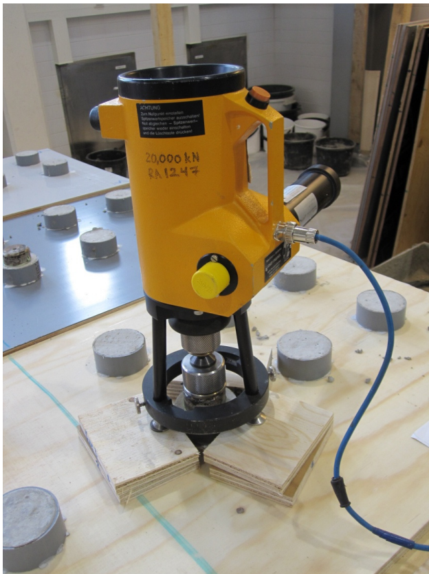
Kuva 19. Easy M – tartuntavetolujuusmittalaite
