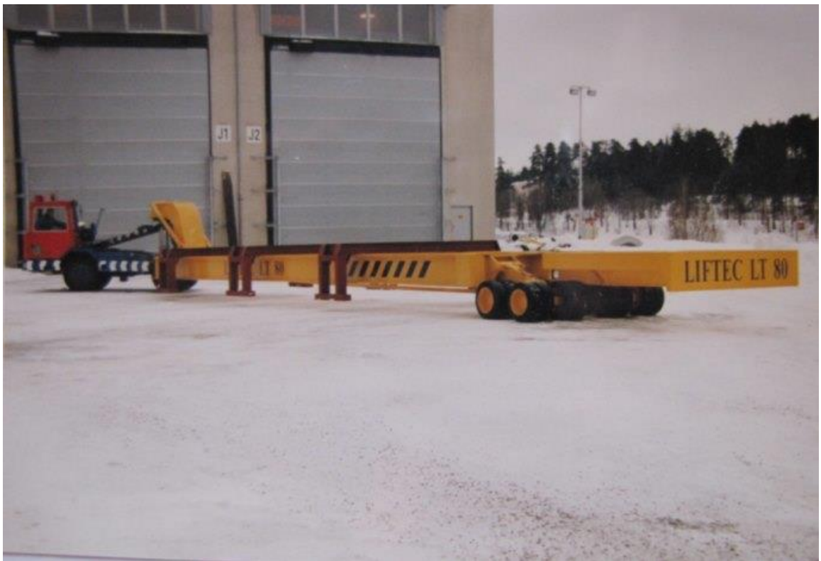
KUVA 1: Nostosiirtovaunu LT 80 (Liftec Productions arkistomateriaalia)
