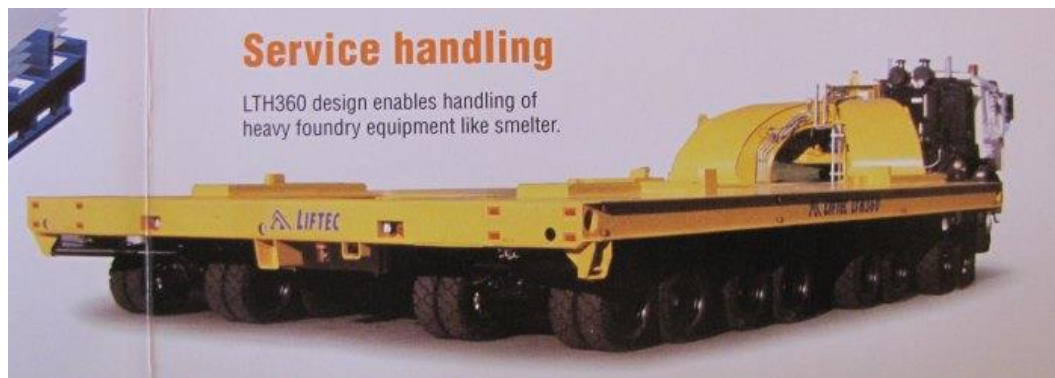
KUVA 2: Jättimäinen 360 tonnin nostosiirtovaunu (Kuva: Liftec Products arkistomateriaalia)
