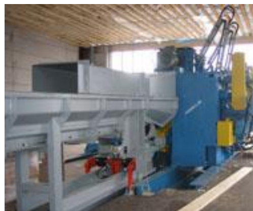
Kuva 6. Kuorimakone (Nordautomation v.2012)
