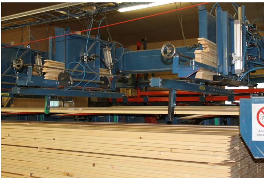
Kuva 28. Välirimoituskone pneumatiikkasyylinterillä Kontiotuote Oy Pudasjärvi
