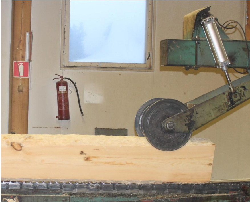
Kuva 27. Pneumatiikkasyylinterituenta rullalle Pölkky Oy Kuusamo
