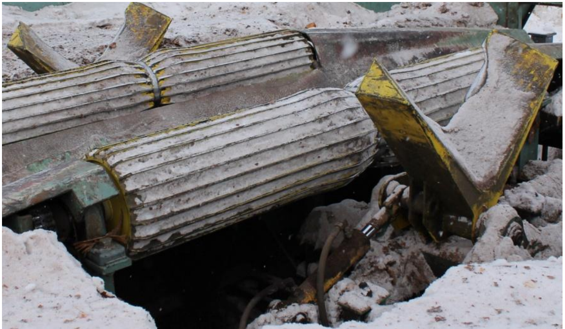
Kuva 20. Hydraulikkasylinteri tukinkääntölaitteessa Kontiotuote Oy
