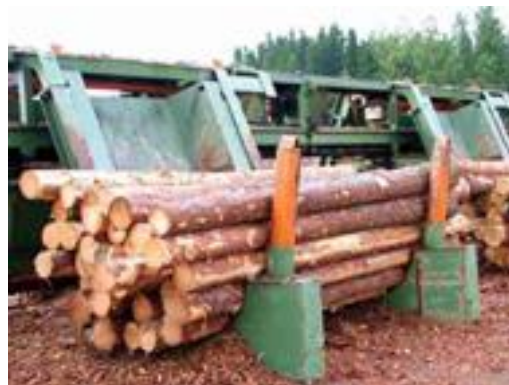
Kuva 4. Tukkilokero (Nordautomation v. 2012)
