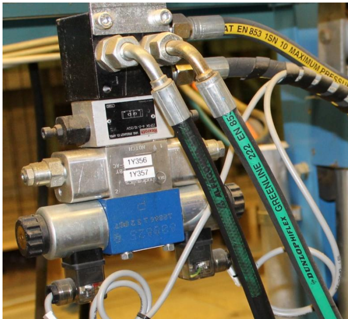
Kuva 22 Suuntaventtiilipaketti salvuulinjalla Kontiotuote Oy
