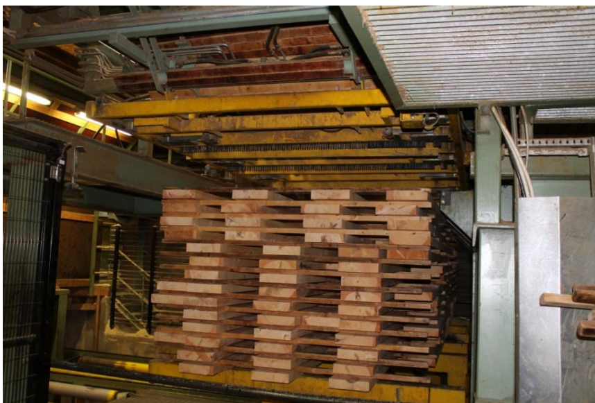
Kuva 12. Rimoituskoneella lähes valmis nippu Pölkky Oy Kuusamo
