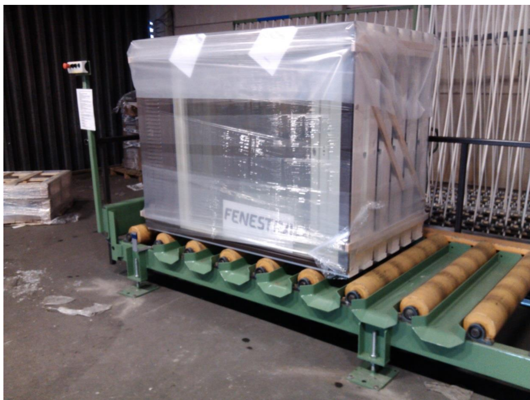
KUVA 2. Tavara pysähtyneenä kuljettimen loppuun (valokuva Juuso Kaplas.)
