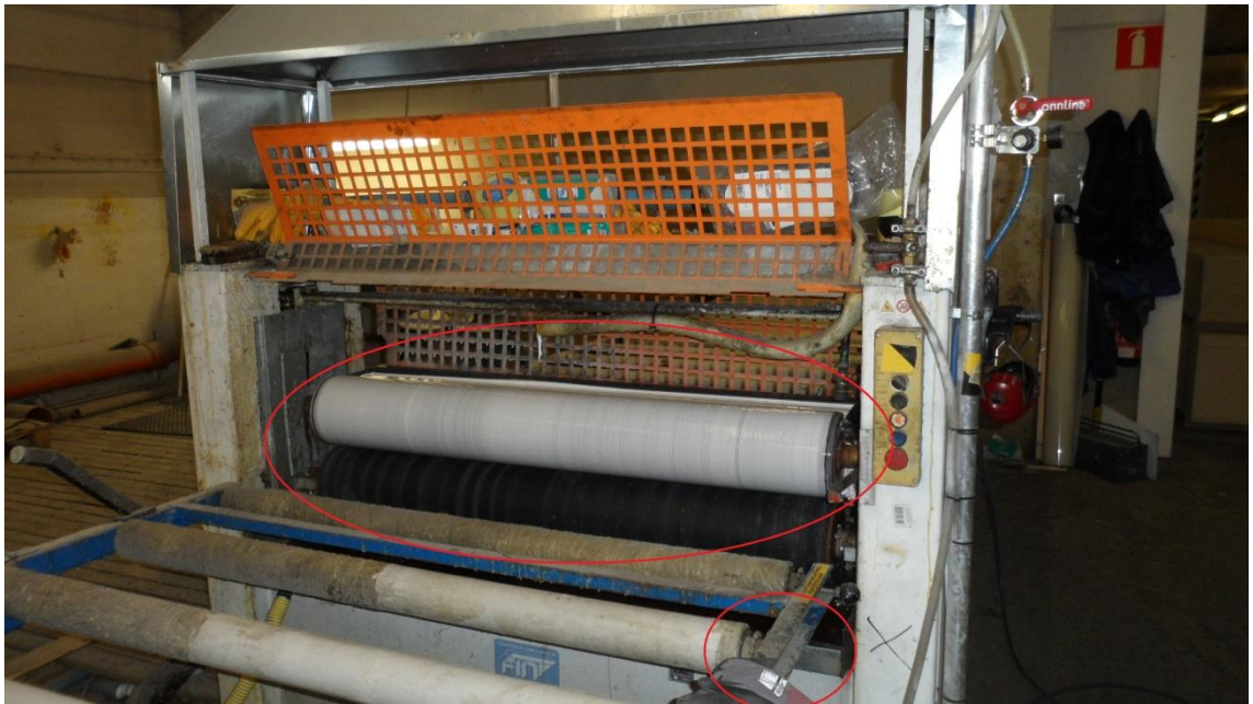
Kuva 7. Yksipuolinen telalevitin, riskialueet ympyröity. (Kuva: Markku Leskinen.)
