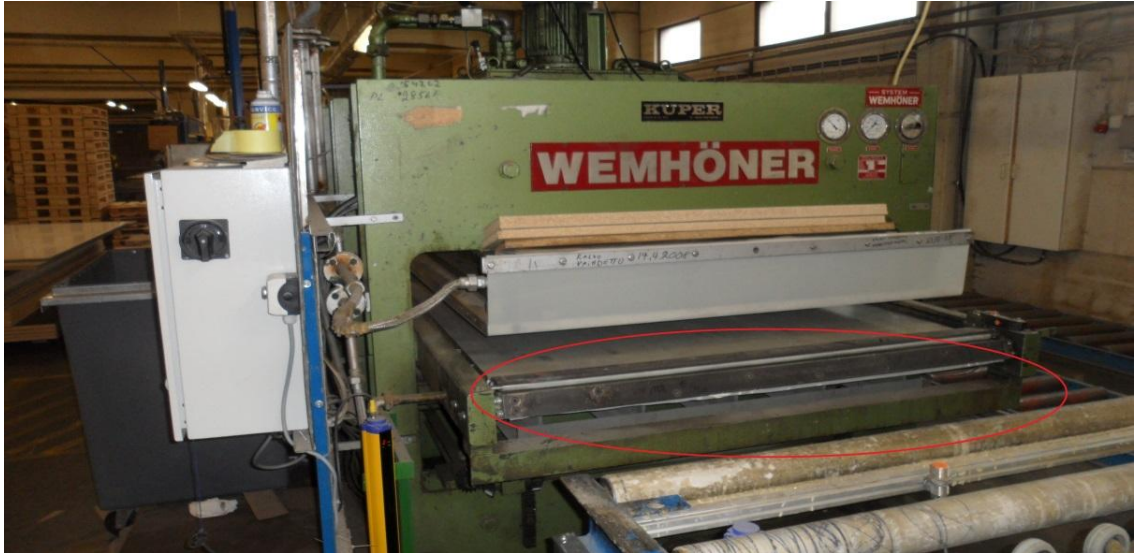
Kuva 8. Levypuristin, riskialueet ympyröity. (Kuva: Markku Leskinen.)
