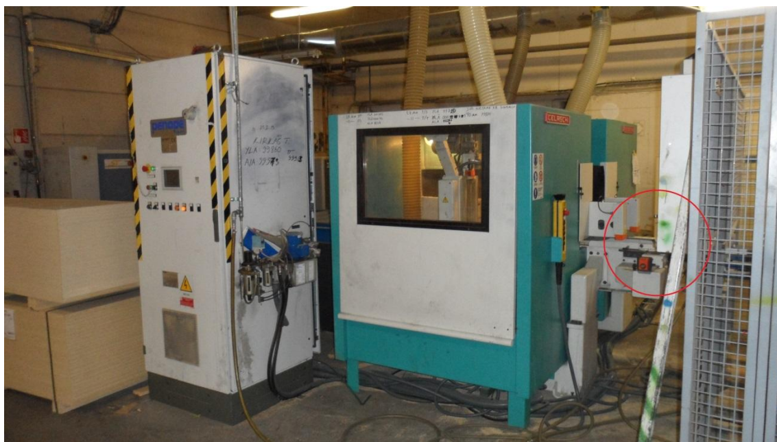
Kuva 6. Kaksoisautomaattinen tappikone-syrjäsaha, riskialueet ympyröity. (Kuva: Markku Leskinen.)
