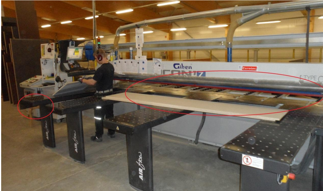
Kuva 14. CNC-ohjattu paloittelusaha, riskialueet ympyröity. (Kuva: Markku Leskinen.)
