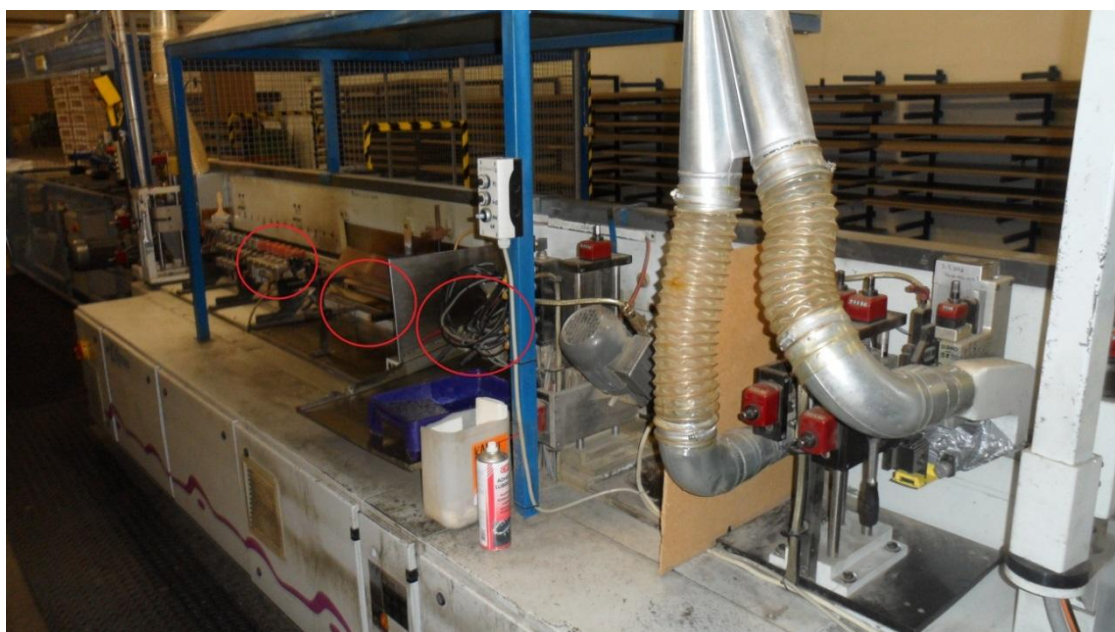
Kuva 9. Taivutuskone, riskialueet ympyröity. (Kuva: Markku Leskinen.)
