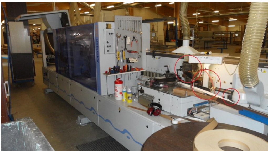
Kuva 12. Reunalistoituskone, riskialueet ympyröity. (Kuva: Markku Leskinen.)
