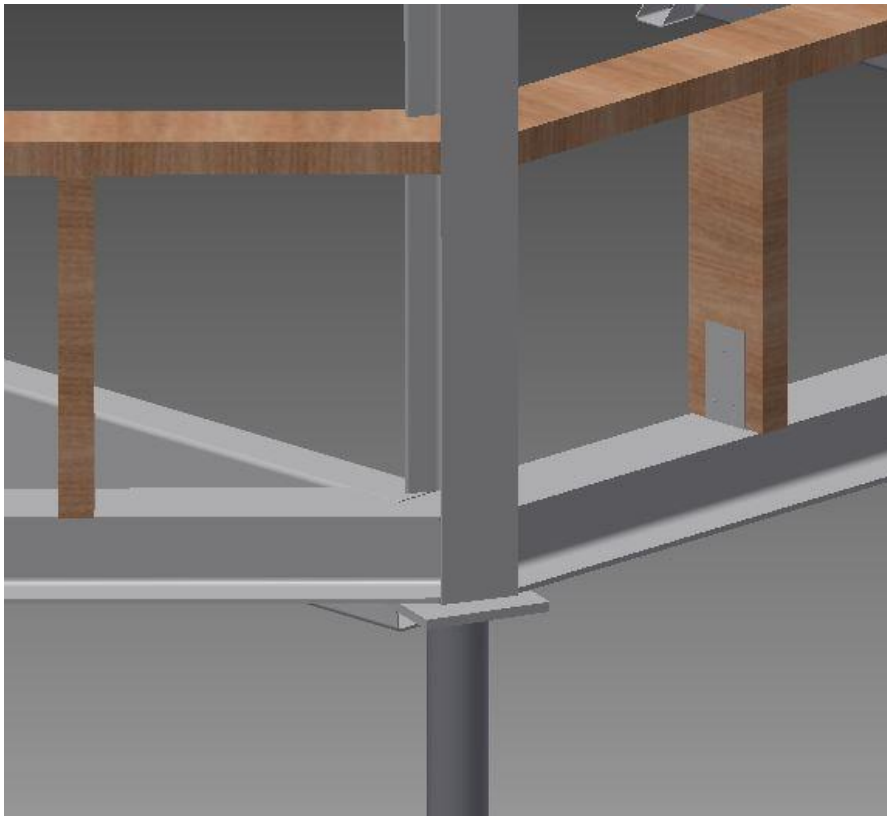
Kuva 28 Teräspaalun liitos lattiaarakenteeseen
