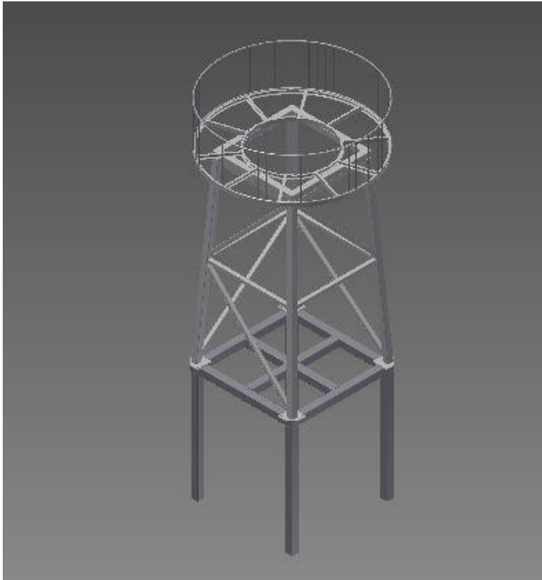
Kuva 34 Alempi- ja ylempi runko, sekä näköalatasanne yhdistettynä
