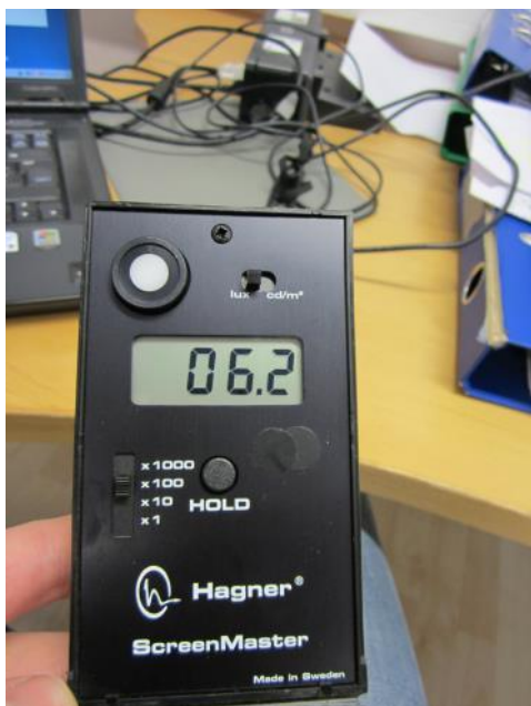
Figur 28. Luxmätare som användes för ljusflödesmätningen.
