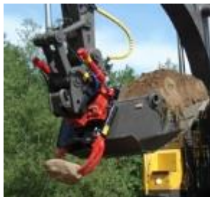
Figur 10. Gripmodul på Rototilt är bra för arbetseffektiverande av stolpmontering.
