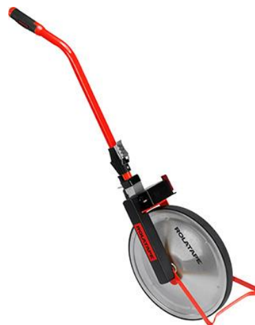
Figur 23. Rolatape hjulmätt som användes vid mätning av vajermått.
