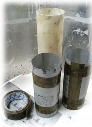
Kuva 77. Kipsivalu muottien teko (Yli-Knuuttila 2013)
