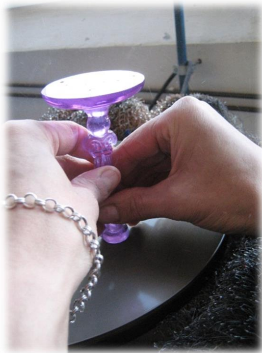
Kuva 119. Viimeistelyä timanttiplaanilla (Virta 2013)
