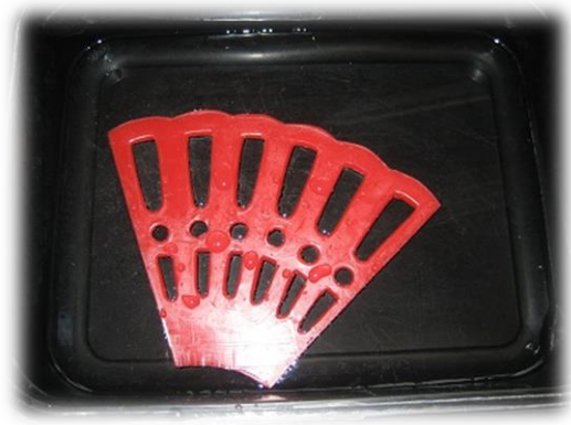
Kuva 56. Vahamalline lämpimässä vedessä (Yli-Knuuttila 2013)
