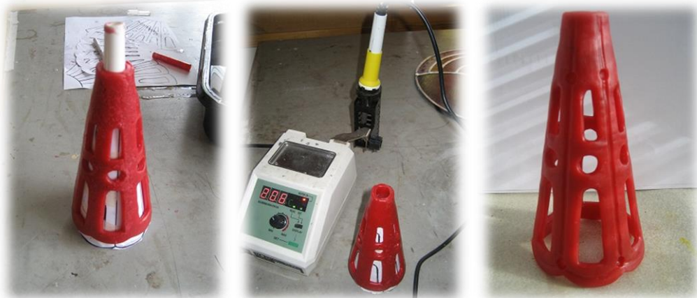
Kuvat 57, 58 ja 59. Vahamallineen muotoilua (Yli-Knuuttila 2013)
