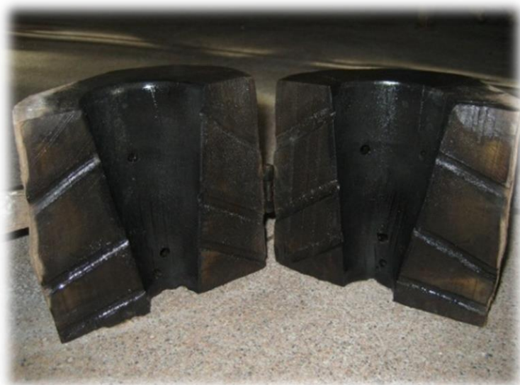
Kuva 43. Avattava ja päästävä puumuotti, jossa näkyvät siihen tehdyt ilmakanavat
