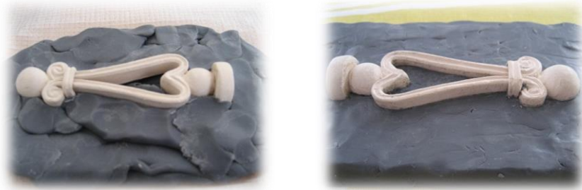
Kuvat 85 ja 86. Plastoliinin muotoileminen savimallineen ympärille (Yli-Knuuttila 2013)
