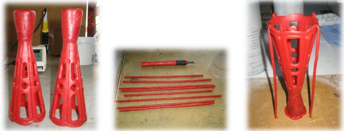
Kuvat 60, 61 ja 62. Valukaukalot (vasemmalla) ja ilmastointiputket (keskellä ja oikealla) (Yli-Knuutila 2013)
