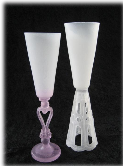
Kuvat 129 ja 130. Valmiit kipsimuotissa toisiinsa yhdistetyt kuohuviinilasit (Yli-Knuuttila 2013)
