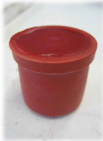
Kuva 99. Kuminen pullonkorkki valumuottina (Yli-Knuuttila 2013)
