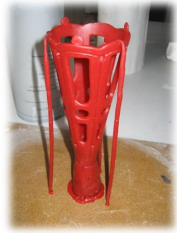
Kuvat 100 ja 101. Vahamallineet ilmastointiputkineen odottamassa kipsivalua (Yli-Knuuttila 2013)
