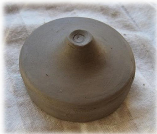
Kuva 65. Savimalline silikonimuottia varten (Yli-Knuuttila 2013)
