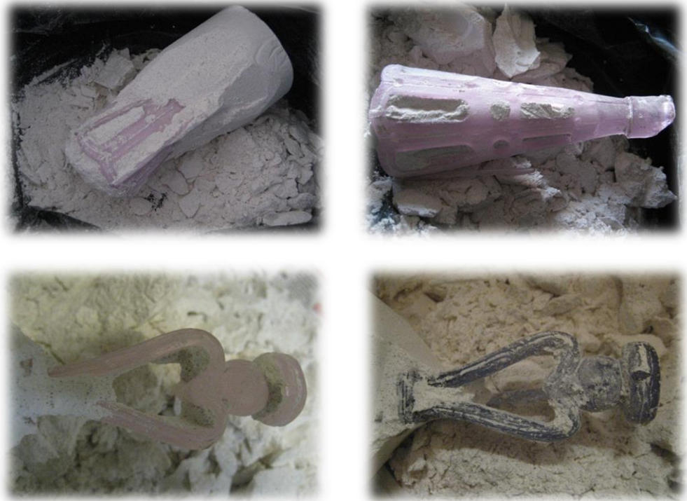
Kuvat 112-115. Jalkaosien purkamista kipsimuoteista (Yli-Knuuttila 2013)
