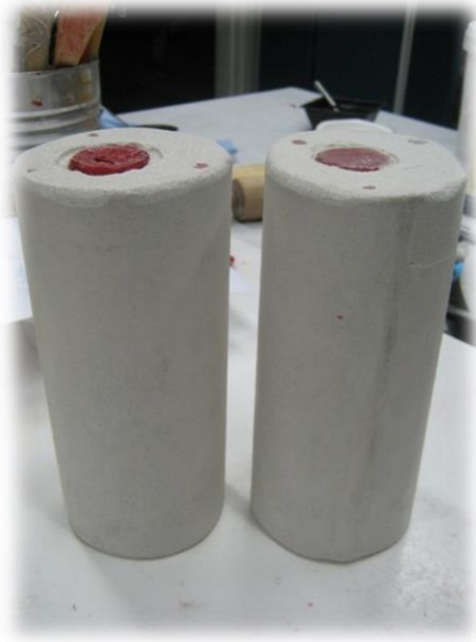
Kuva 80. Vahat valettuina kipsimuotteihin (Yli-Knuutti 2013)
