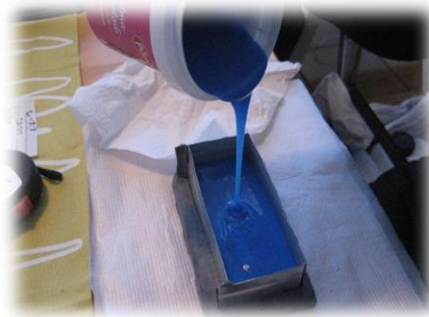
Kuva 87. Silikonin kaataminen muottiin (Yli-Knuuttila 2013)
