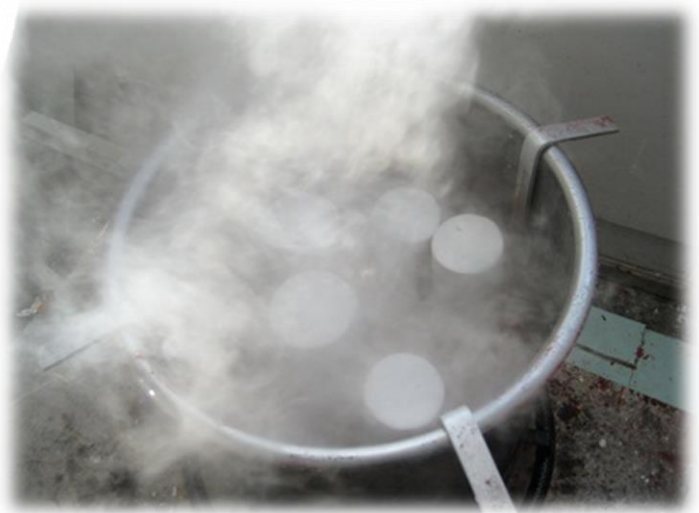
Kuvat 105 ja 106. Vahan höyryttäminen pois kipsimuotista (Yli-Knuuttila 2013)
