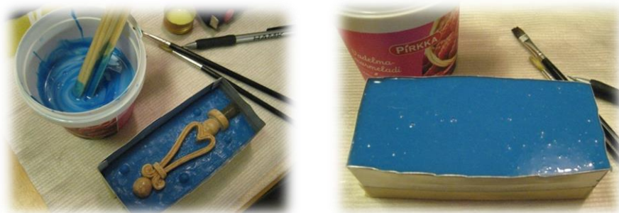
Kuvat 88 ja 89. Silikonimuotin toisen puolen valu (Yli-Knuuttila 2013)
