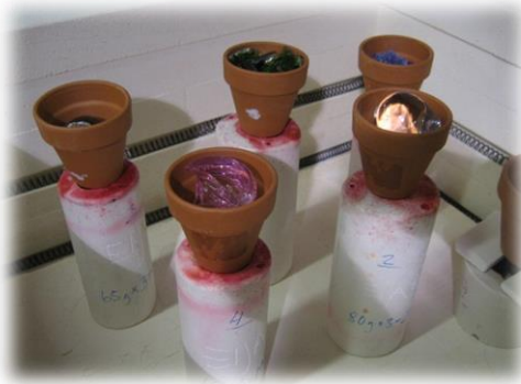
Kuvat 109 ja 110. Muotit valmiina sulatukseen (Yli-Knuuttila 2013)
