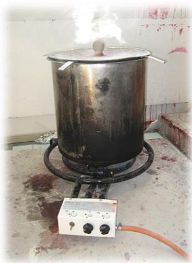
Kuvat 105 ja 106. Vahan höyryttäminen pois kipsimuotista (Yli-Knuuttila 2013)
