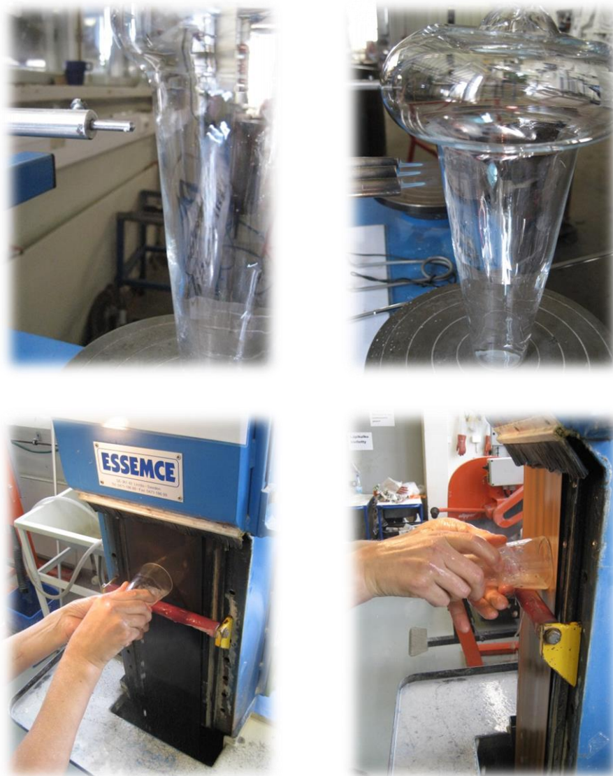
Kuvat 44-47. Lasin katkaisu kylmäkatkaisukoneella ja hiominen nauhahiomakoneella
