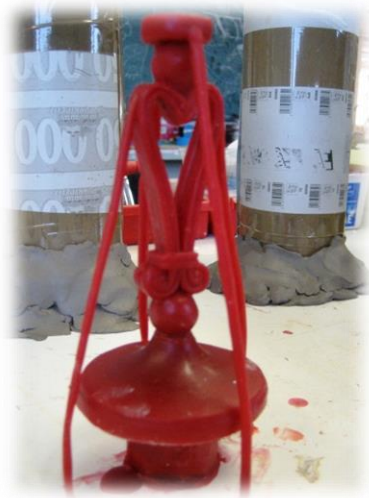
Kuvat 100 ja 101. Vahamallineet ilmastointiputkineen odottamassa kipsivalua (Yli-Knuuttila 2013)
