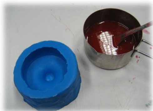
Kuva 71. Valmis silikonimuotti (Yli-Knuuttila 2013)
