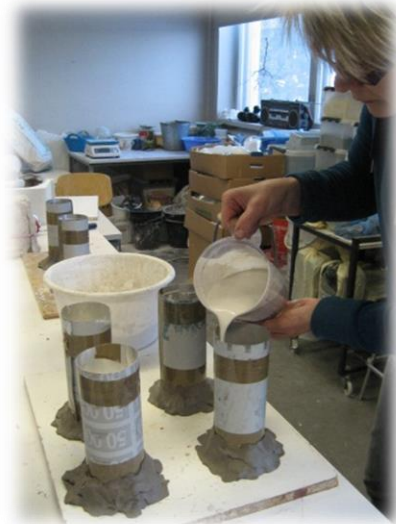
Kuvat 102 ja 103. Hydracast kipsi ja valaminen muotteihin (Yli-Knuuttila/Virta 2013)
