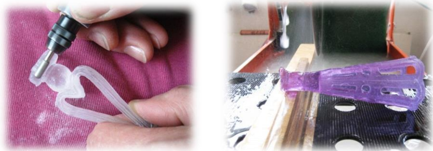
Kuvat 116 ja 117. Lasinyppyjen poistamista ja sahausta (Virta, Yli-Knuuttila 2013)
