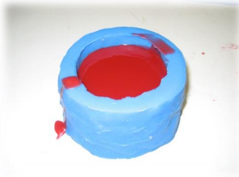
Kuva 72. Sula vaha valettu muottiin
