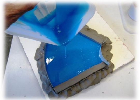
Kuvat 91 ja 92. Vahamalline ja silikonimuotin valu (Yli-Knuuttila 2013)
