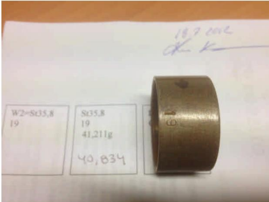
Kuva 1. Kuva on anturin päässä olleesta painohäviöpalasta
