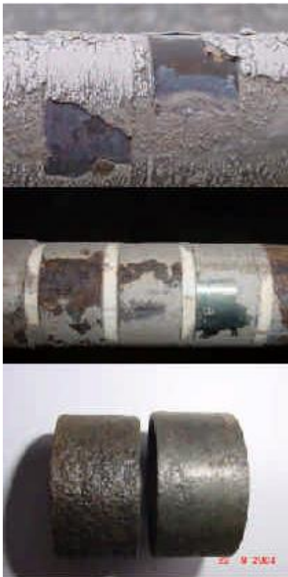
Kuva 11. MoCo DP -järjestelmän koepalat (11.)
