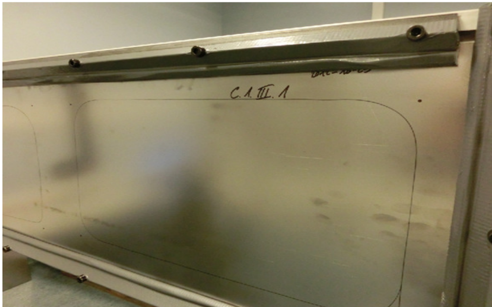
Kuva 14. Laserilla tehty peilikuvio ovilevyssä.
