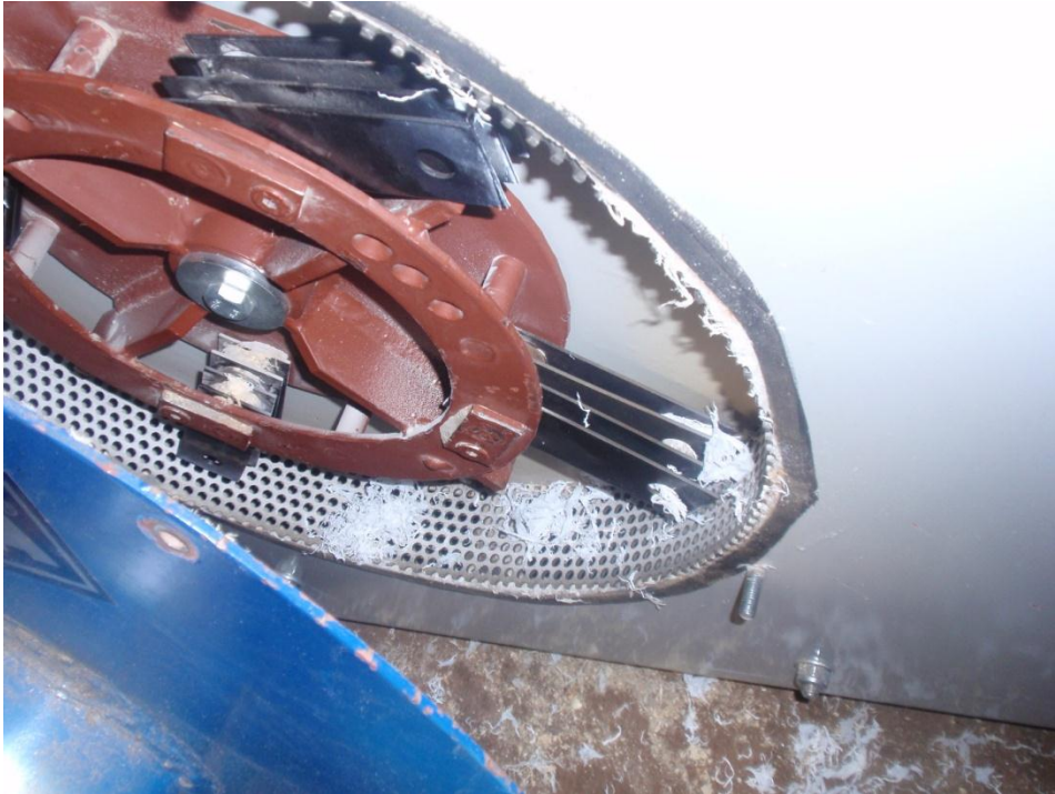
KUVA 3. Vasaramylly (kuva: Ville Savela)
