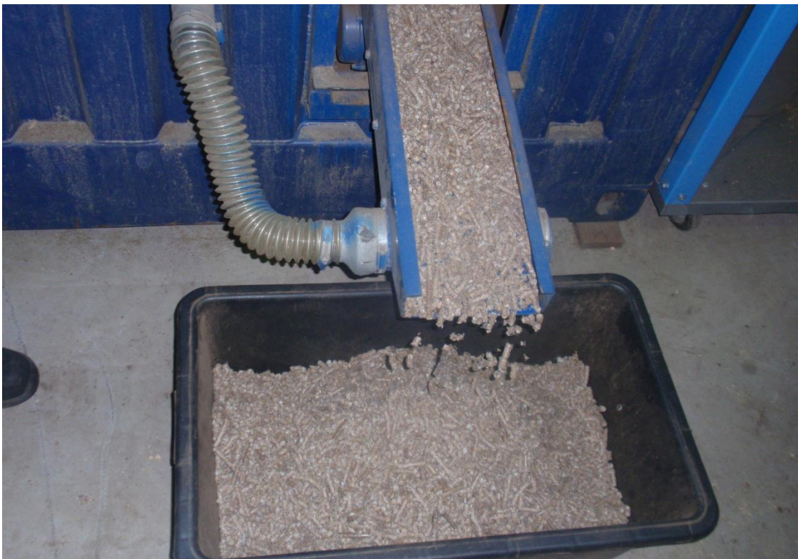
Kuva 8. Pelletin laskeminen jäähdystornista pois (kuva: Ville Savela)
