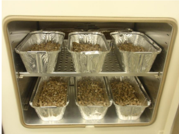
KUVA 12. Pelletin kosteudenmääritys lämpökaapissa (kuva: Ville Savela)
