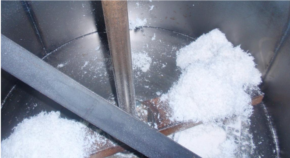
KUVA 10. Pienittyä muovisilppua välisäiliössä (kuva: Ville Savela)
