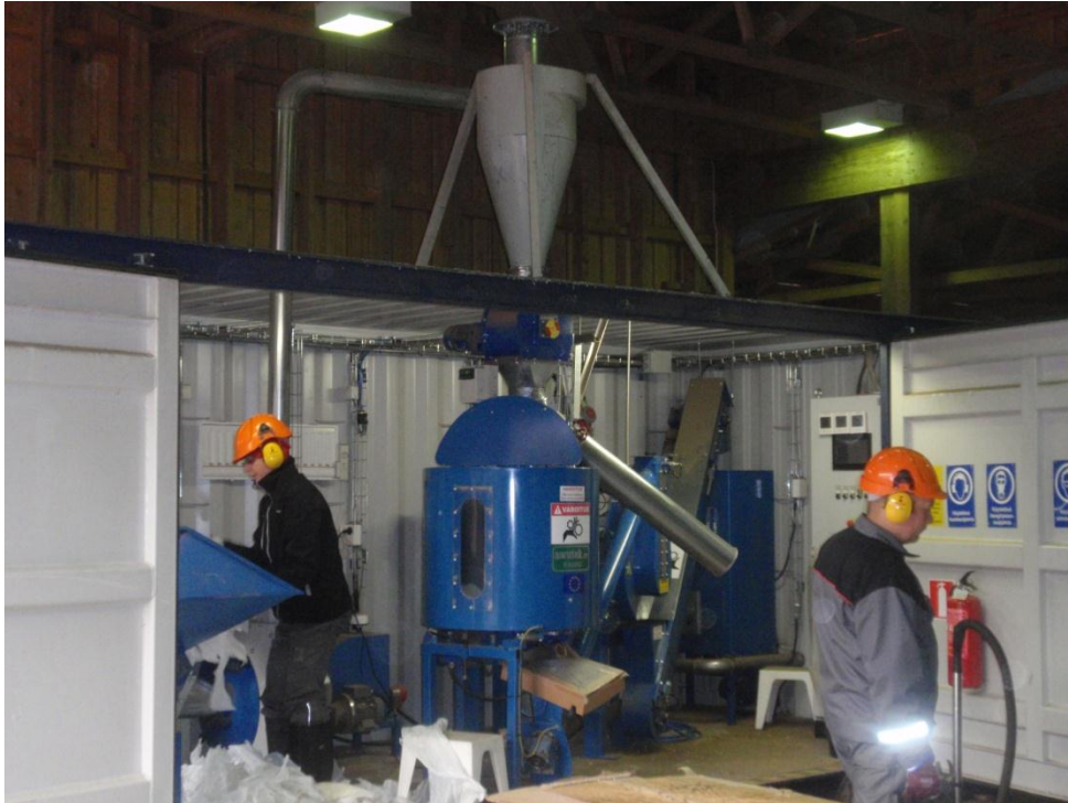
KUVA 4. Kuvassa on keskellä välisäiliö ja kontin päällä sykloni. (kuva: Ville Savela)
