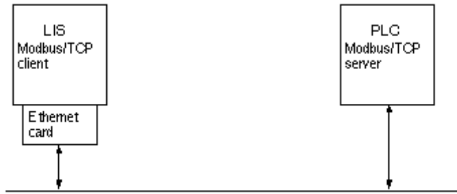
KUVA 8. Modbus/TCP:n periaatekuva MetsoDNA:ssa (3.)
