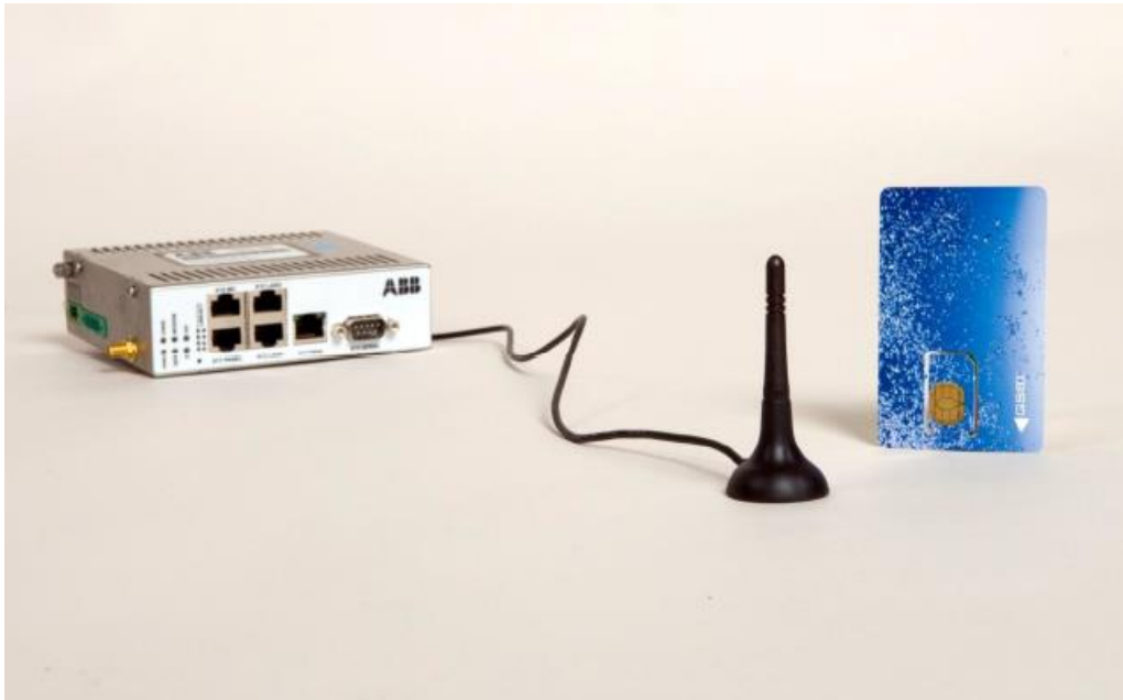
Kuvio 3. Remote Service -laitteisto. Etäyksikkö, antenni ja sim-kortti. [6]
