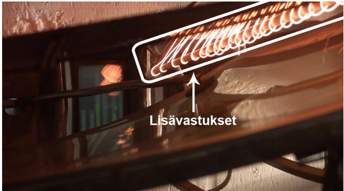
Kuva 8. Taivutusuunin sisällä käytettävä lisävastus.
