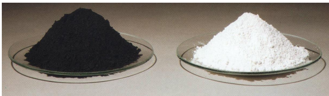
Kuva 2. Raaka-aineena käytettävää mustaa ilmeniittiä ja valmista titaanidioksidipigmenttiä. /2, s. 7/
