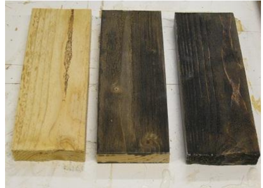
KUVIO 34. Kosteustestipalat vasemmalta oikealle: normaali, kuumatervattu ja perustervattu.
