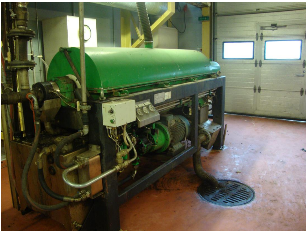
Kuvio 7. Stormossenin kuivauslinko, jossa kuivataan mädätettyä puhdistamojätettä.
