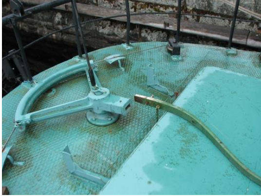
KUVA 32. Peräsimen hätäohjauksen kääntövarsi.
