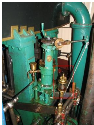
KUVA 15. Märkäilmapumpulla sijaitseva tiputusvoitelusäiliö
