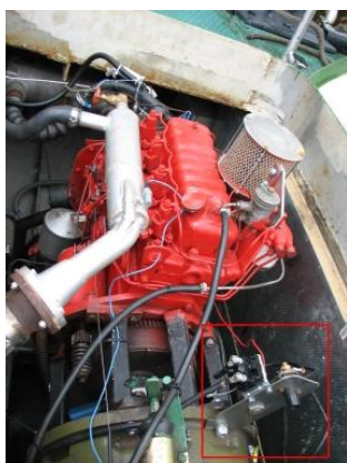
KUVA 30. Dieselmoottorin päävirta ja käynnistysavain.
