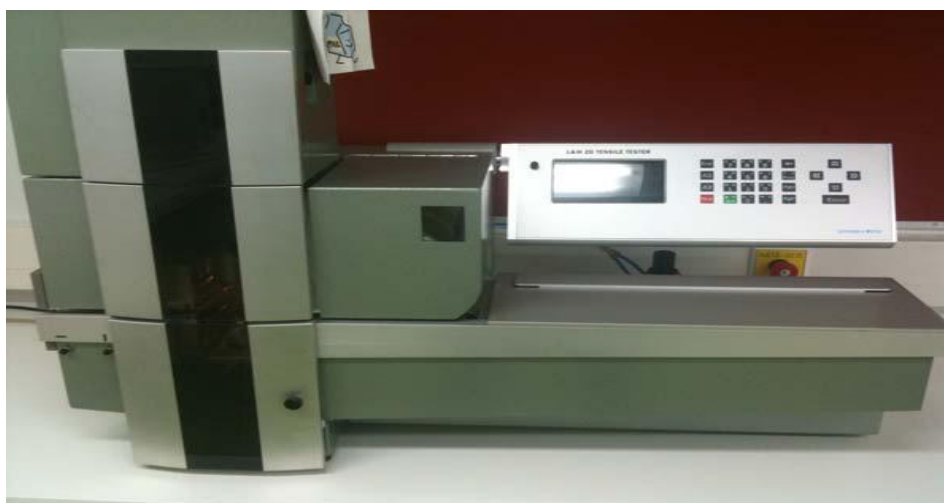
Kuva 7. Z-suuntaisen lujuuden mittaamiseen käytetty laite
