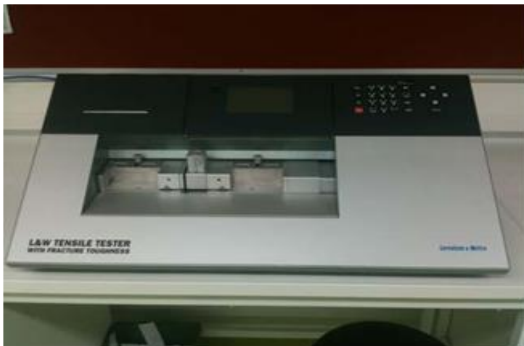
Kuva 5. Murtositkeyden, vetolujuuden ja venymän mittaamiseen käytetty laite
