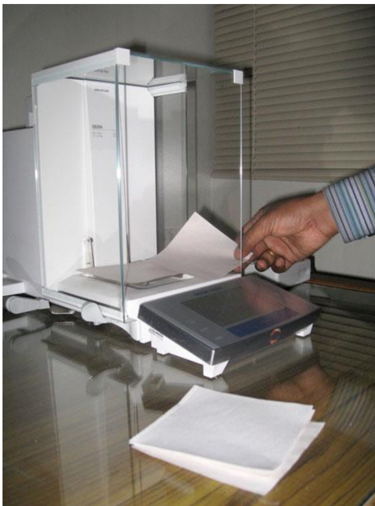
Kuva 2. Neliömassamittauksessa käytettävä vaaka
