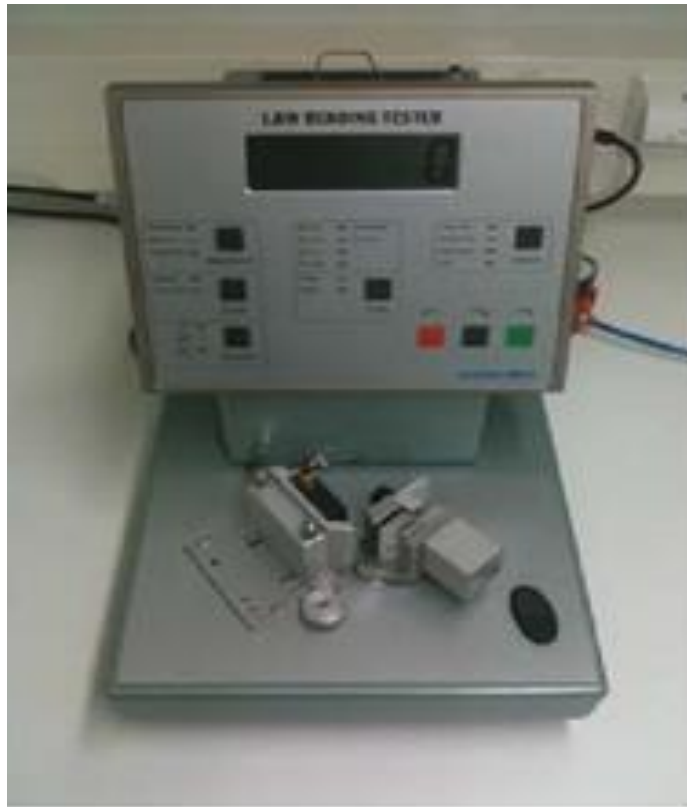
Kuva 8. Jäykkyyden mittaamiseen käytetty laite
