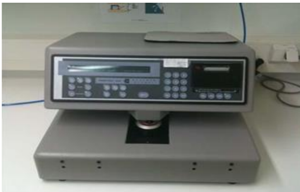
Kuva 6. Sileyden mittaamiseen käytetty laite
