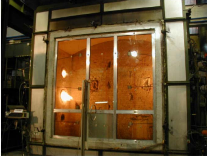
Kuva 2. Lasirakenne EN-standardin mukaisessa palonkestävyyskokeessa (Ala-Outinen 2007)
