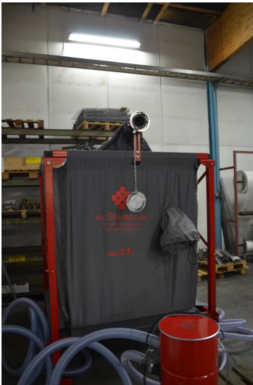
Kuva 2. Pellettien varastointiin tarkoitettu säkksiilo ja pneumaattisena siirtojärjestelmänä pelletti-imuri. (Juho Ruohonen 2013)
