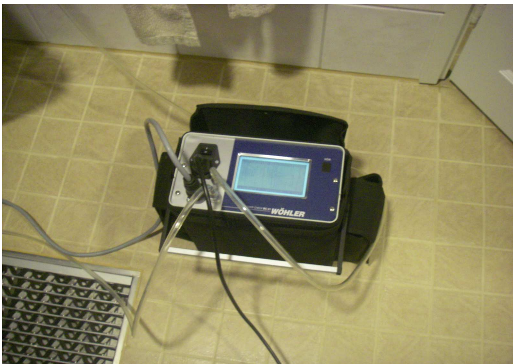
Kuva 4. Ilmanvuotomittauslaitteiston keskusyksikkö asennettuna.
