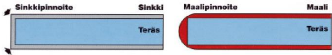
KUVA 9. Sinkkipinnoitteen peittokyky terävissä reunoissa (Kuumasinkityksen toimintaketju 2007, 2.)
