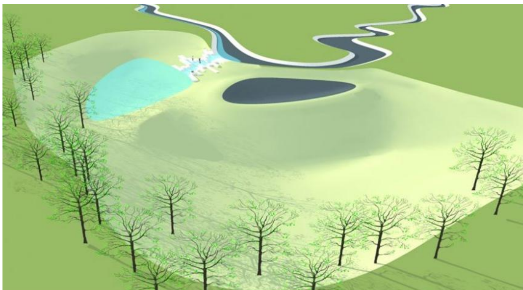
KUVIO 5. Esimerkki pieneltä osin täyttyneestä laajasta hulevesialtaasta, joka toimii kuivana ollessaan ulkoilupuistona, mutta voi tarpeen vaatiessa myös täyttyä kokonaan vedellä. Kohde sijaitsee Tanskan Roskildessa. (Kuva: Facebook 2013.)
