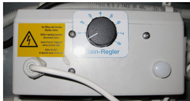
Figur 14. Joniseringsaggregatet har inställbar joniseringsspänning med skalan 0-8, där läget 0 är av.
