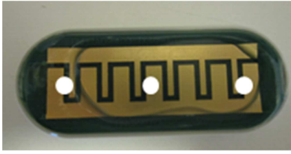
KUVA 16. Enurad 400 -sensorin mittauskohdat
