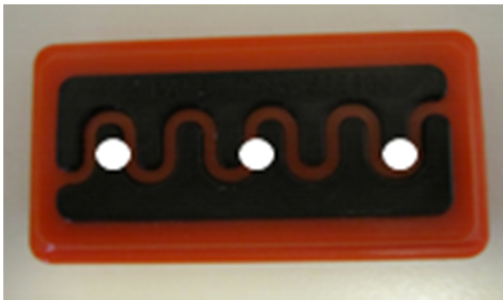
KUVA 17. DRI Sleeper Eclipse Urosensorin mittauskohdat
