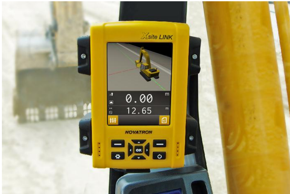
Kuva 2. Kaivinkoneen koneohjausjärjestelmä (Novatron.fi).
