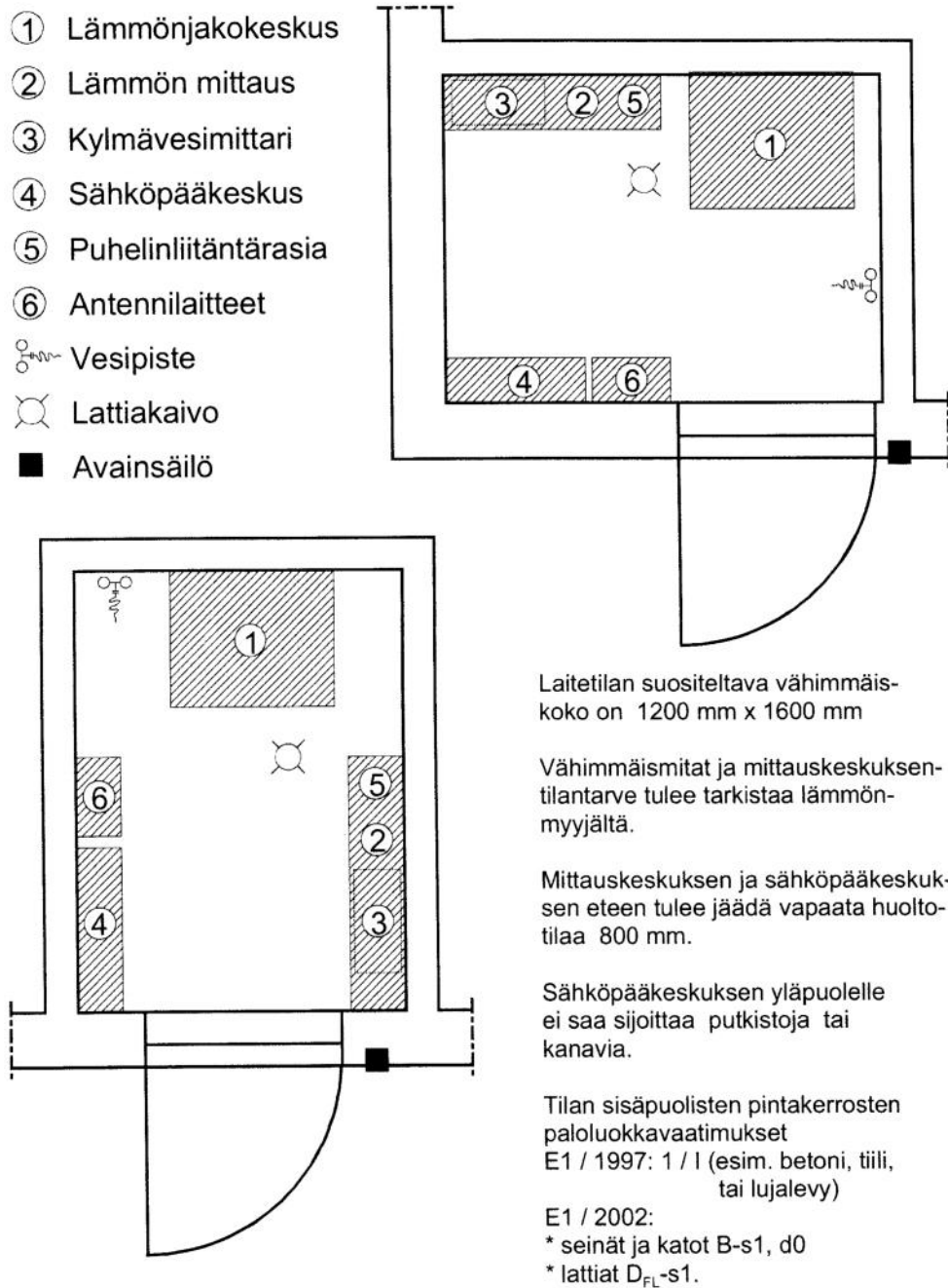
Kuva 4. Lämmönjakohuoneen mitoitus (30).
