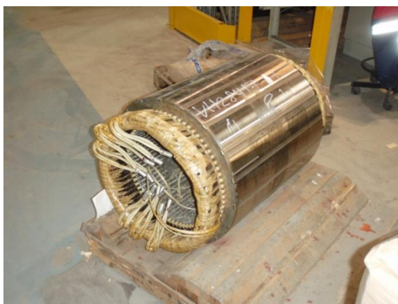
Kuva 7. Käämitty ja hartsattu staattoripaketti
