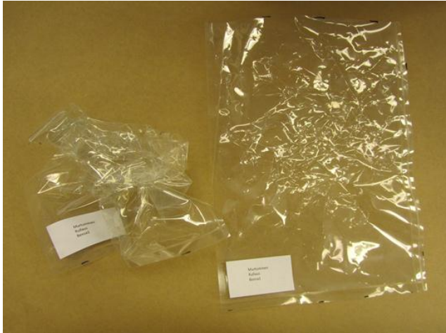
Kuva 14. AMPAC-pussin kestävyystesti pussia auki rullaamalla.
