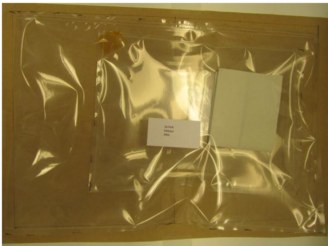
Kuva 12. AMPAC-pussin diffuusiotesti tuplapussimenetelmällä, jolloin näyte otetaan pussien väliin jäävästä välitilasta.
