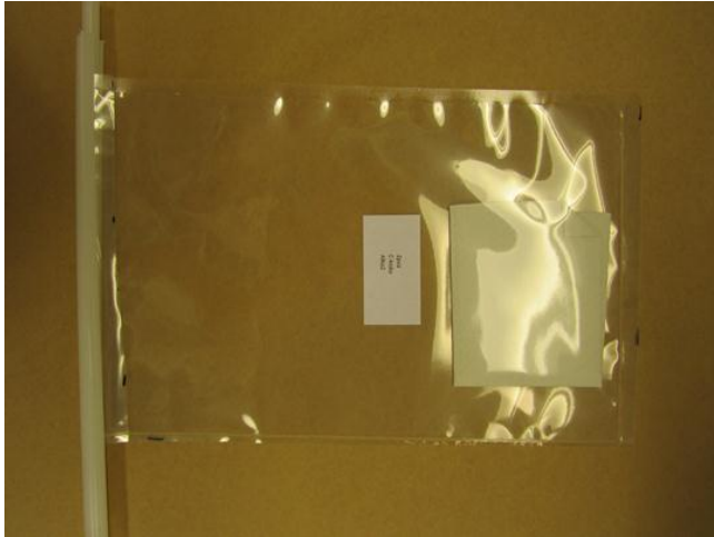
Kuva 13. AMPAC-pussi suljettuna C-kiskolla.
