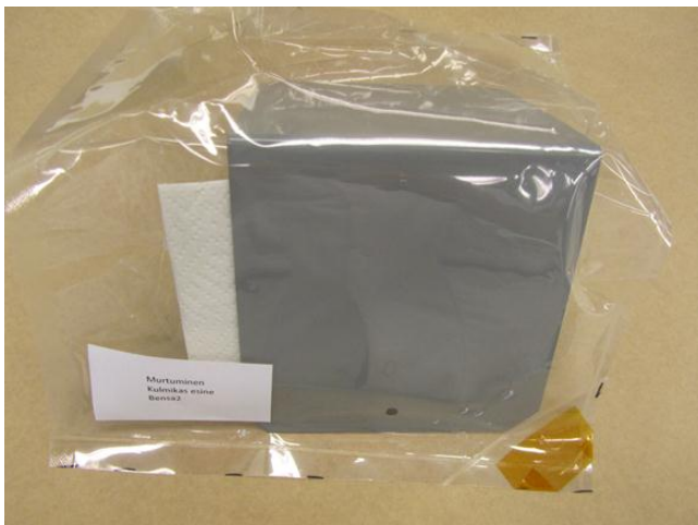
Kuva 16. AMPAC-pussin kestävyystesti, kun sisällä kulmikas esine.
