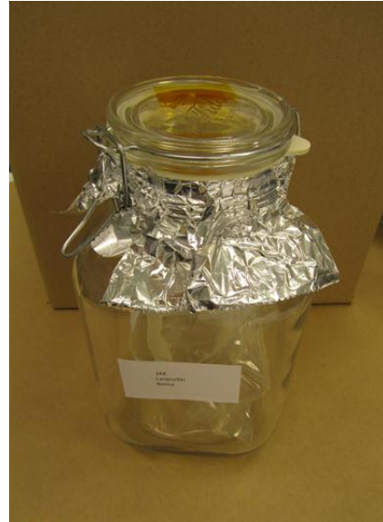
Kuva 11. Pussi lasipurkin sisällä. Kannen tiivistää kumiiviste ja folio. Kanteen oli porattu reikä HS-näytteen ottoa varten.
