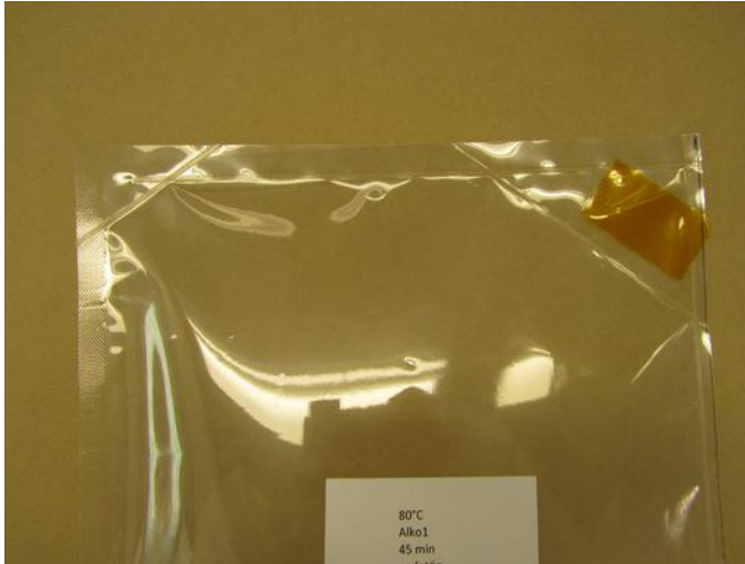
Kuva 6. Pussin saumaus: vasemmassa reunassa on rako ilman pumppausta varten ja oikean reunan kohta saumattu näytteen lisäyksen jälkeen.
