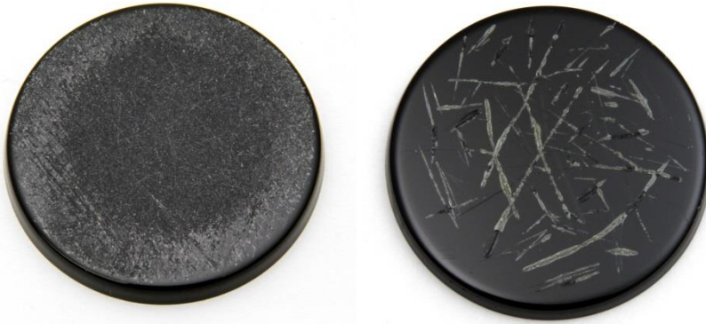
KUVA 6. Vasemmalla on hiekkapaperilla naarmutettu sulate ja oikealla poranterällä naarmutettu sulate
