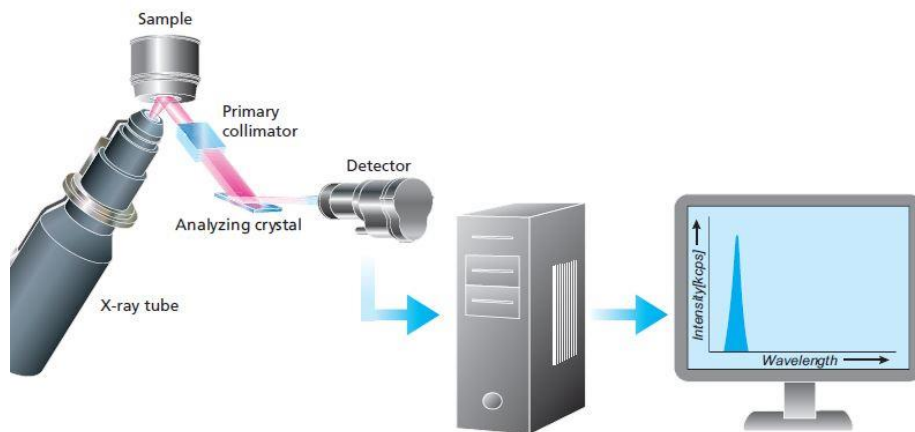
KUVA 5. Aallonpituusdispersiivisen XRF-laitteen rakenne (5)
