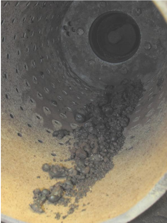
Kuva 14. Polttimen sisään kertynyttä metallimaista klinkkeriä
