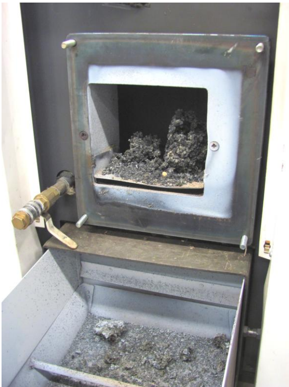
Kuva 10. Olkipellettiä poltettaessa muodostunut valkea tomu ja klinkkeri
