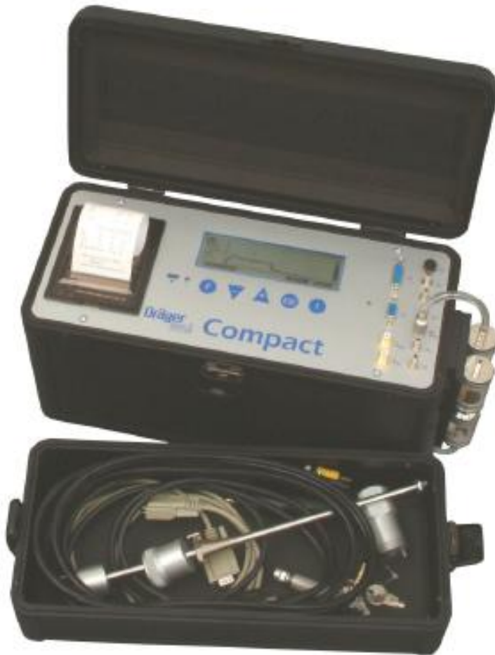
KUVA 4. Drägerin MSI Compact –savukaasuanalysointilaitte (6)
