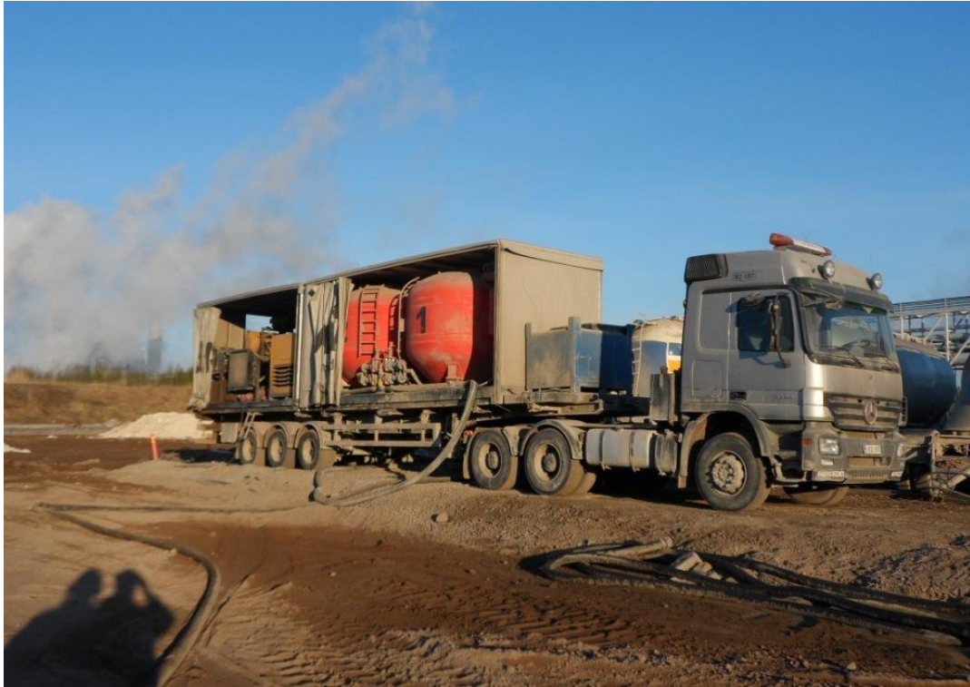
KUVA 12. ALLU PFM on rakennettu puoliperävaununtrailerin päälle.
