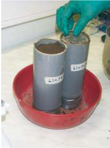
KUVA 5. Sideaineen stabiloituvuus testataan laboratorionkokein (Allu Finland 2007).
