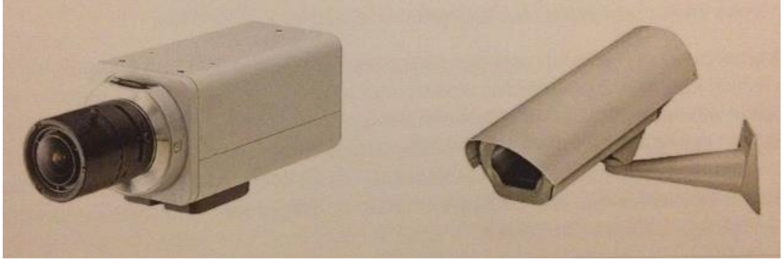
Kuva 2. Kiinteä sisä- ja ulkokamera (Ellonen ym. 2011, 17).
