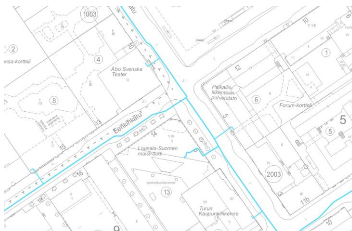
Kuva 24. Turun keskustan kaukokylmäverkostoa.
