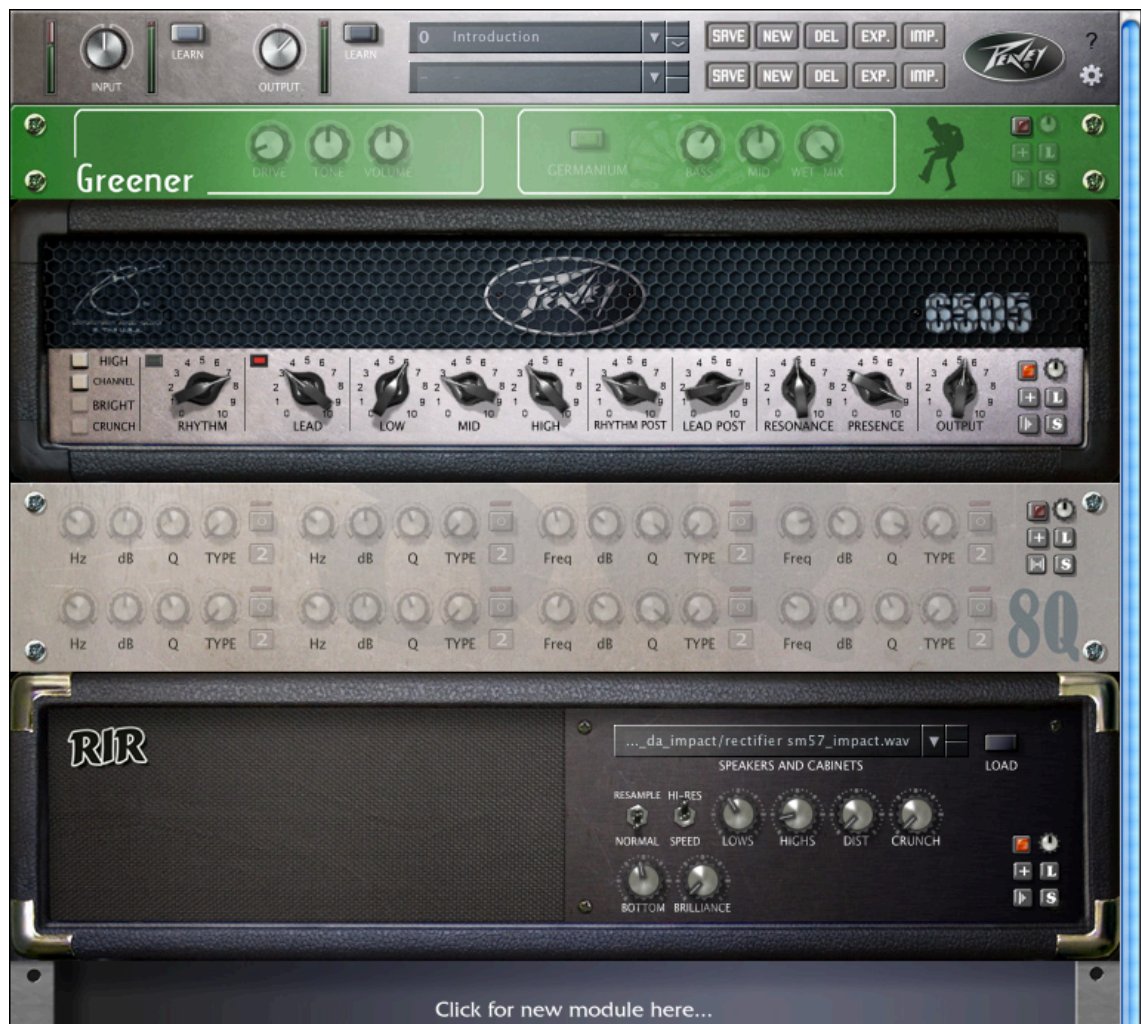
KUVA4: Peavey Revalver MKIV asetukset. Signaalitie : Greener (Ibanez Tubescreamer -säröpedaalimallinnus) ohitettuna, 6505 -mallinnus, 8Q taajuuskorjain ohitettuna ja kaiutinimpulssivaste (Kuva: Miska Reuhkala).
