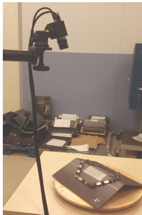
Kuva 3. Venymien mittaaminen särmäysnäytteistä ARGUS optisen mittauksen avulla.
