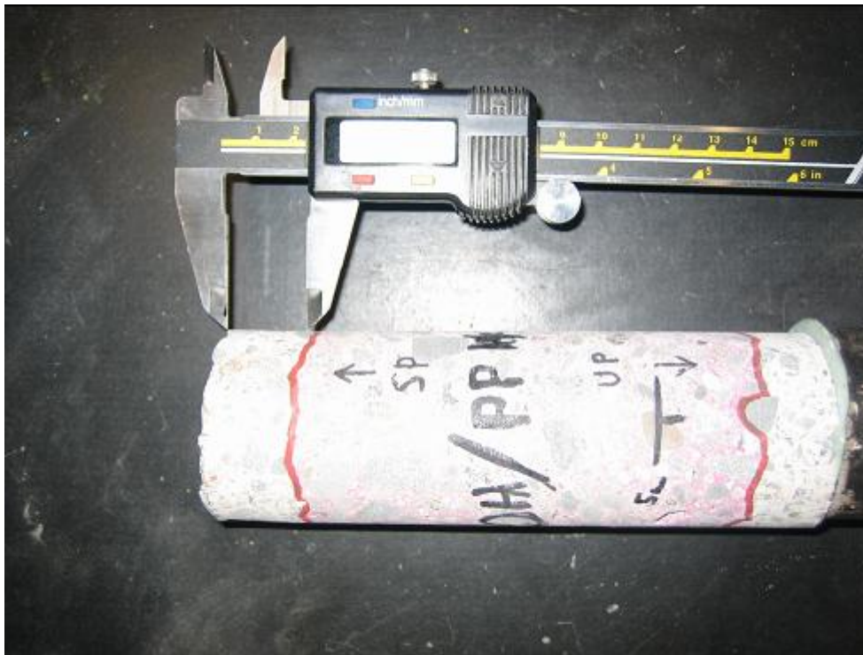
Kuva 2. Karbonatisoitumissyvyyden mittaaminen työntömitalla (12).
