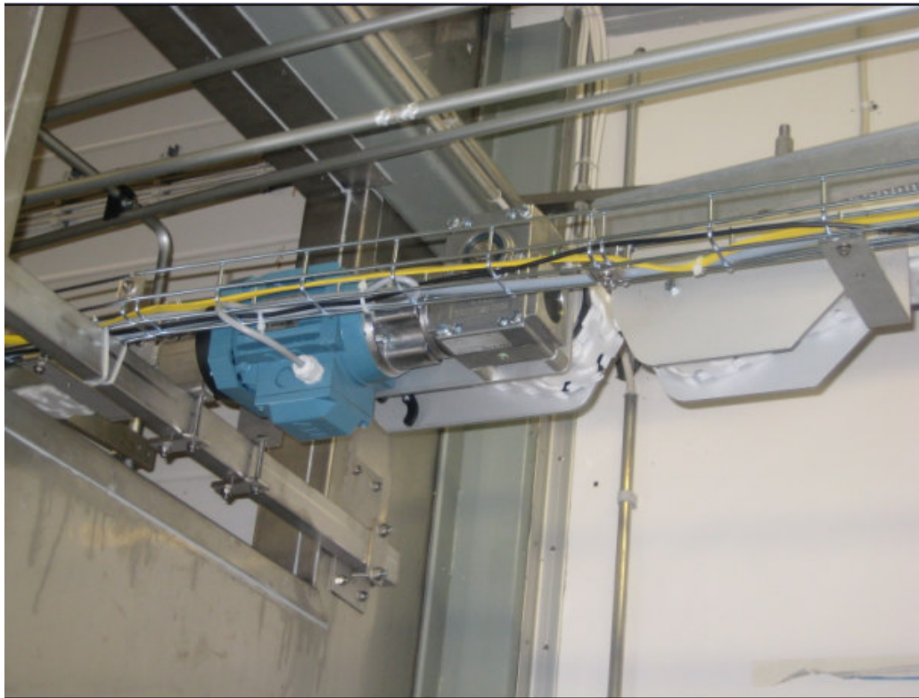
Kuva 2. Kuljetinmoottori johon on liitetty kulmavaihte
