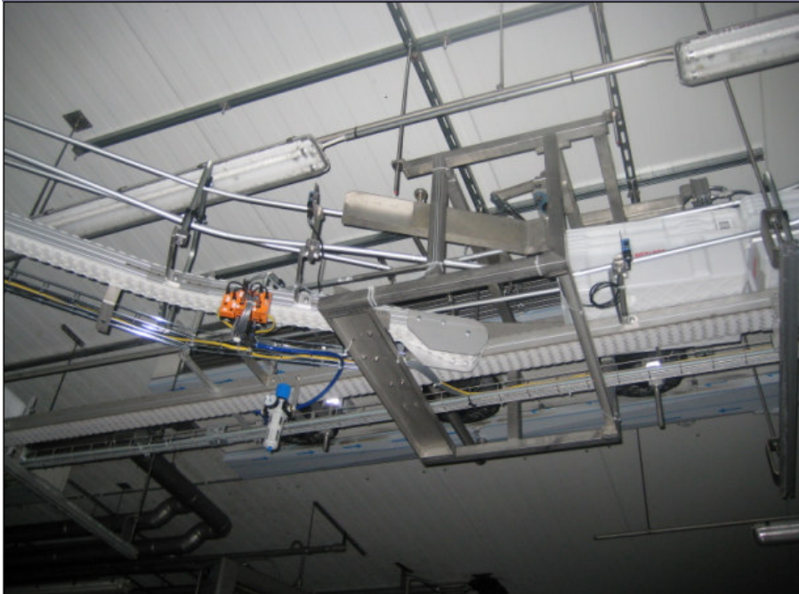
Kuva 6. Risteysvaihte, joka liittää uuden järjestelmän vanhaan järjestelmään.
