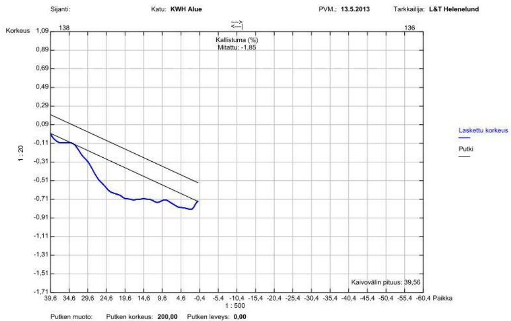
Kuva 31. Robottikameran mittaama linjan kaato. /36/
