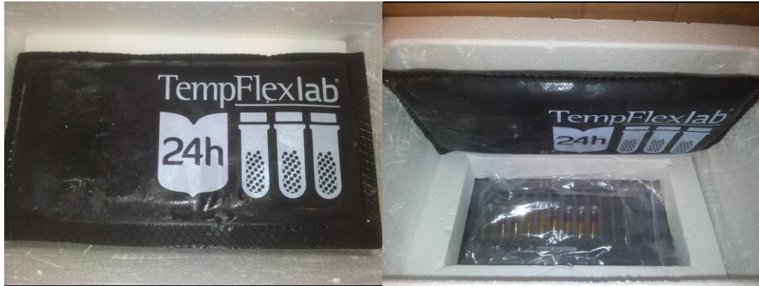
Kuvio 1. TempFlexLab® 24h -kylmävaraajageeli ja näytteiden pakkaus. Yksi geelijää asetetaan laatikon pohjalle, jonka päälle näytteet ja mahdollinen lämpötila-antura asetetaan. Kolme kylmägeeliä asetetaan näytteiden päällä olevan korokkeen päälle.
