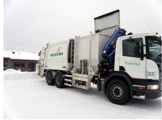
Kuva 8. Kaksilokeroinen jätepakkaaja. Etummainen säiliö kipataan sivulle ja takimmainen työntämällä jätapaali takaa ulos. Kuva Vestia.
